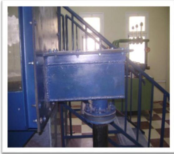
Figure 1.5 : Photographie d'une boîte en charge
