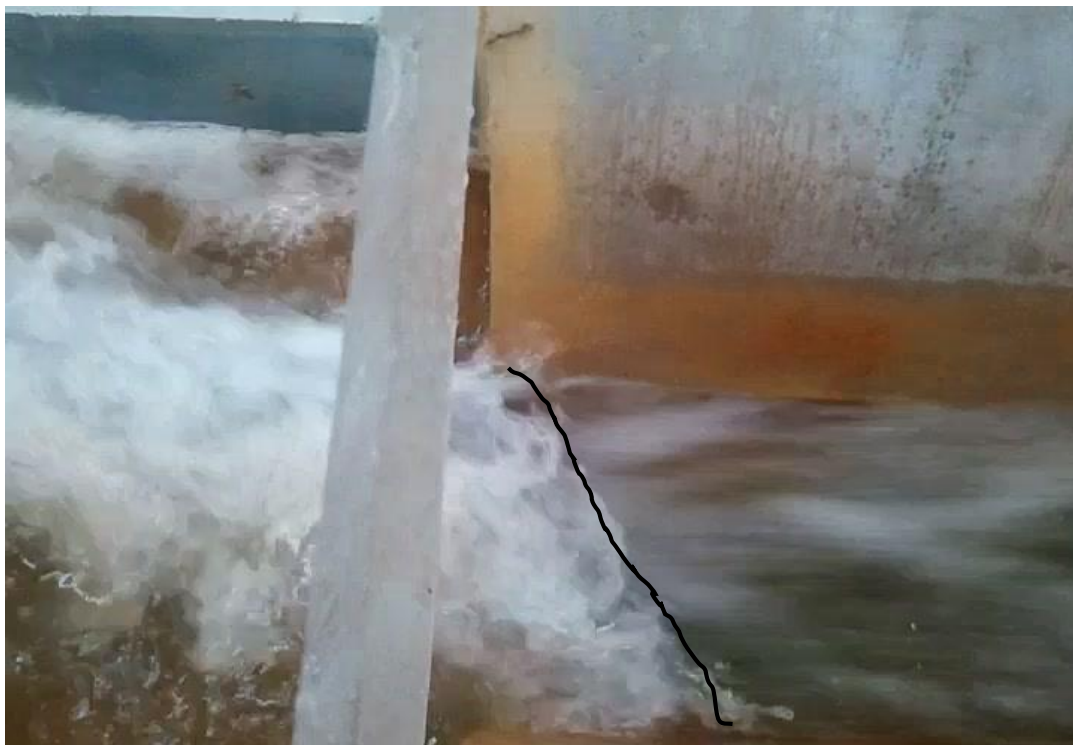
Figure 2.7 : Photographie de la forme oblique du pied du ressaut
