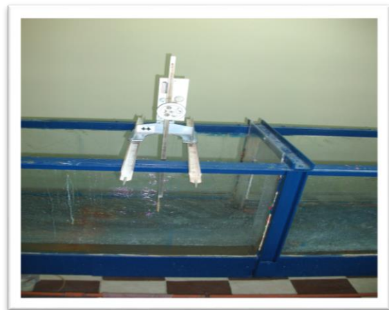
Figure 1.4 : Photographie du déversoir sans hauteur de pelle avec contraction latérale
