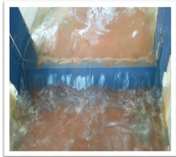
Figure 1.7 : Photographie des seuils utilisés dans l'expérimentation
