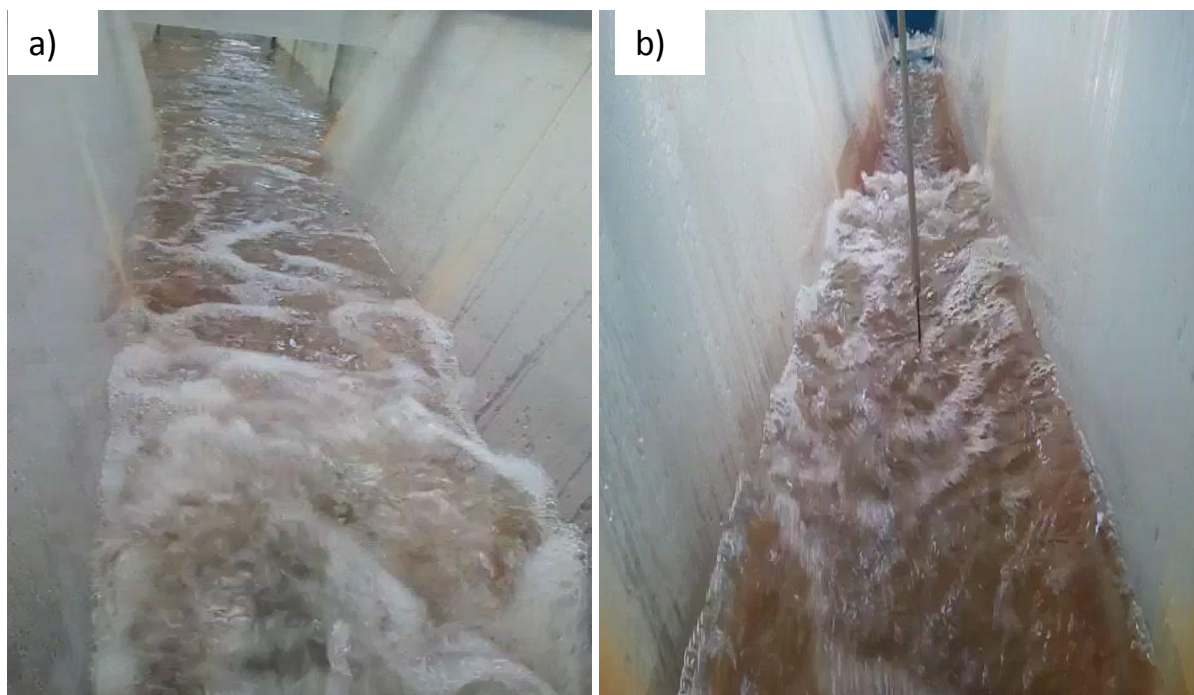
Figure 2.2 : Photographies du ressaut formé complètement dans le canal trapézoïdal ; a) selon le sens de l'écoulement ; b) au sens inverse à l'écoulement
