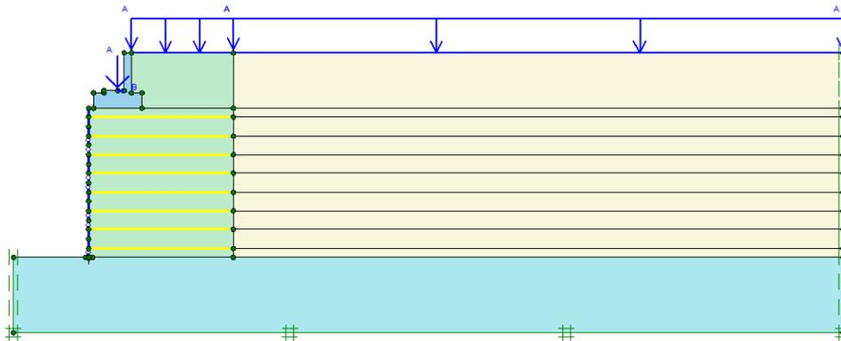
**Figure 5.3** Modèle numérique d'une culée en remblai renforcé
