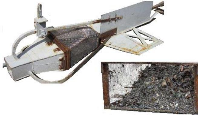
**Figure 88** Nasse Type Helley-Smith (Camenen et al, 2012)
