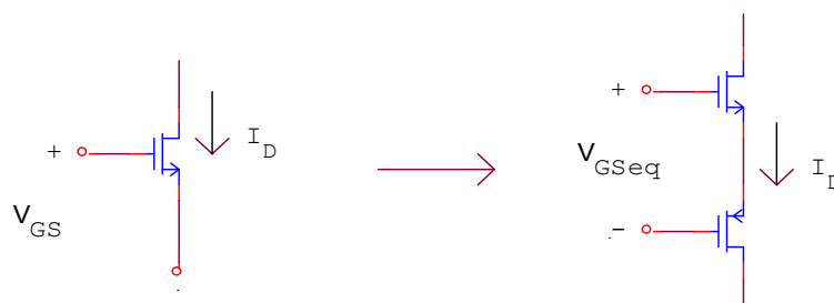
Figure 1.12 : Remplacement du transistor simple par la double paire CMOS.
