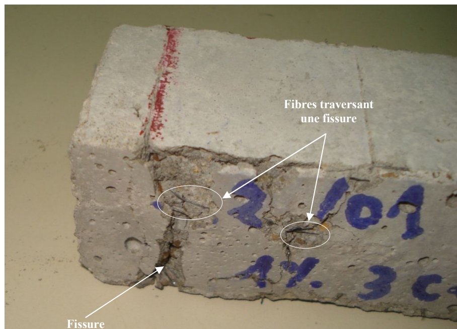
Photo IV.2 : Eprouvette après écrasement, montrant le pontage des fissures par des fibres métalliques issues de pneus usés.
