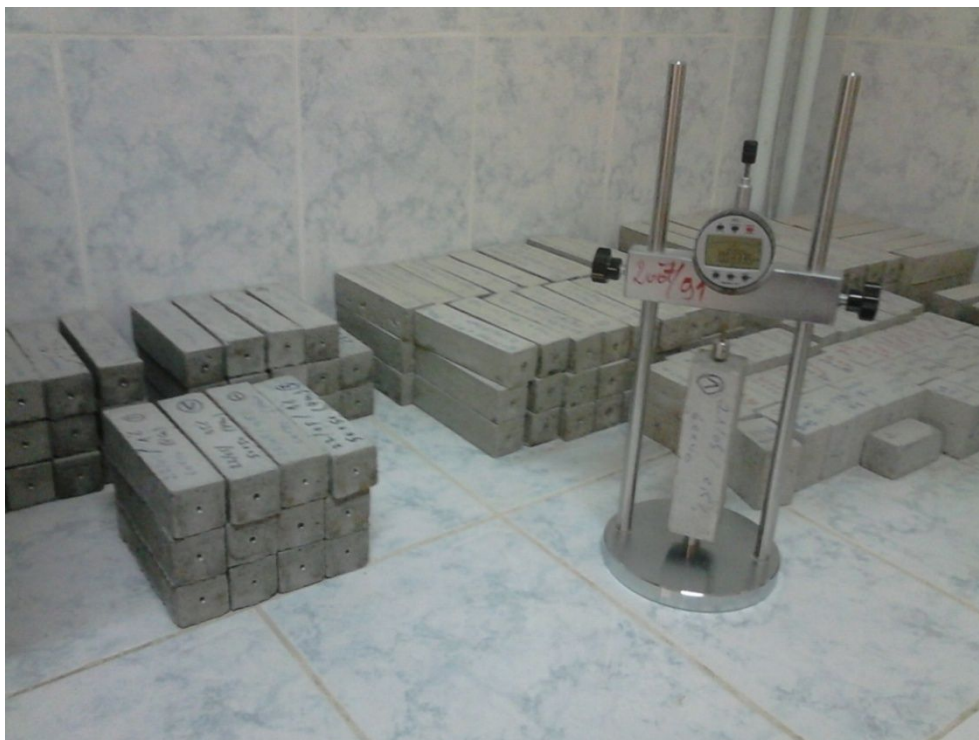
Photo 01: Eprouvettes destinées à la mesure du retrait.
