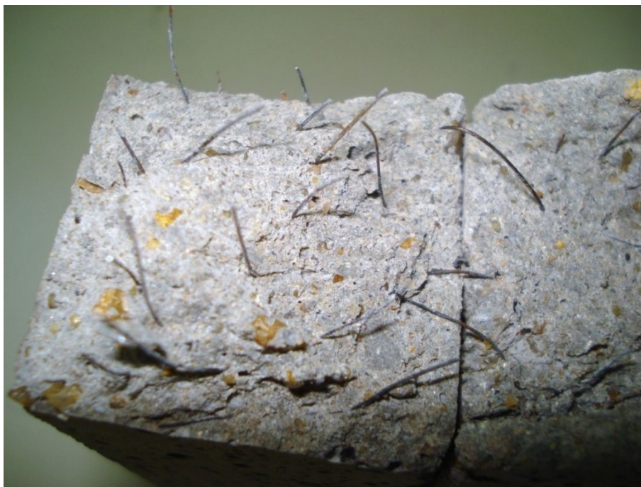
Photo 02 : Béton de sable de dunes renforcé de fibres métalliques issues de pneus usés. Cette coupe transversale montre la répartition des fibres au sein de la matrice.
