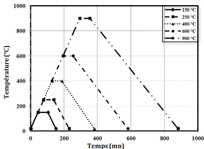
**Figure II.7.** Cycles de chauffage-refroidissement (vitesse de chauffage 3°C/min).
