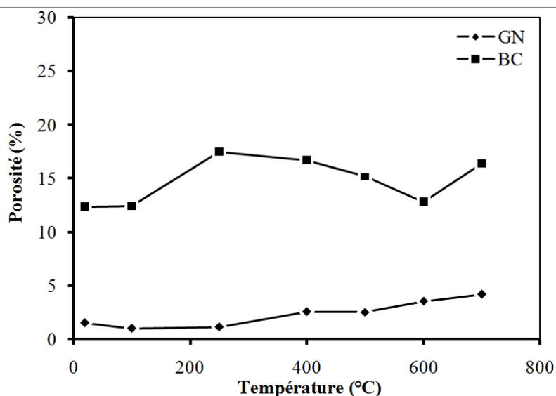
Figure III.4. Evolution de la porosité des granulats avec température.
