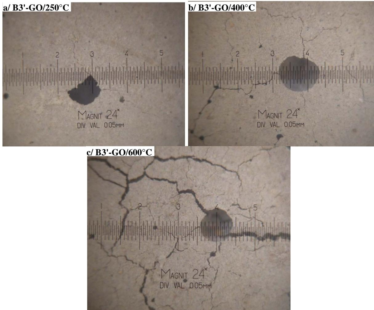
**Figure III.28.** Fissuration à la surface des éprouvettes de B3'-GO après traitement thermique à 250°C, 400°C et 600°C.
