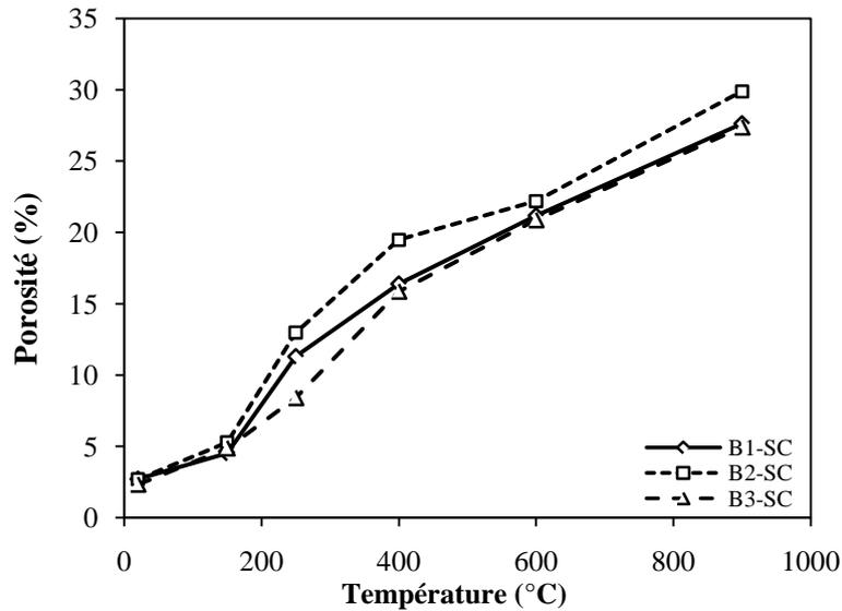
**Figure III.15.** Évolution de la porosité à l'eau des bétons à base de sable concassé en fonction de la température.
