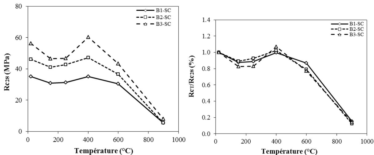
**Figure III.19.** Evolution de la résistance résiduelle et relative en compression des bétons à base de sable concassé en fonction de la température.
