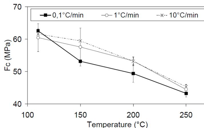
**Figure I.27.** Effet de la vitesse de montée en température sur l'évolution de la résistance en compression du béton avec la température [Gallé et al., 2003].
