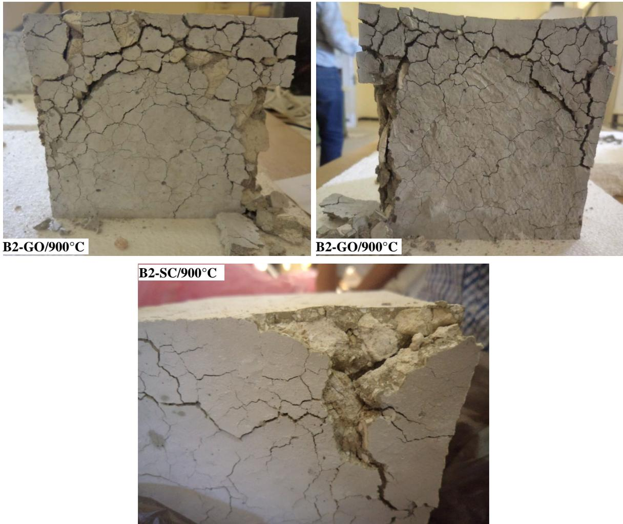
**Figure III.29.** Ecaillage de quelques éprouvettes après chauffage à 900°C.
