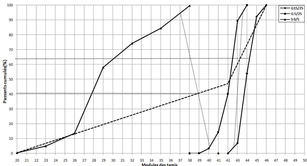
**Figure II.2.** Courbes granulométriques du sable siliceux, gravillon et gravier calcaires.
