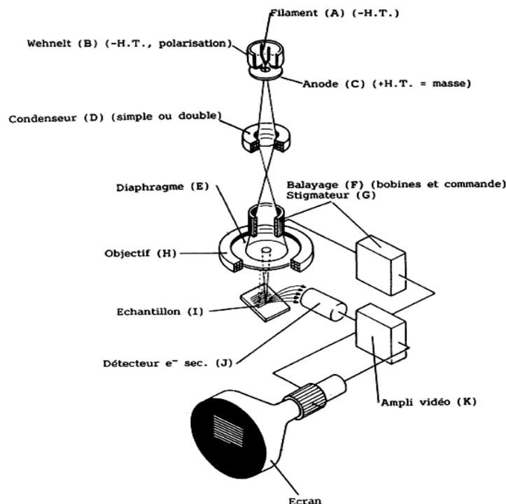
Figure II.19. Schémas de principe du Microscope électronique à balayage [Faerber, 2004].
