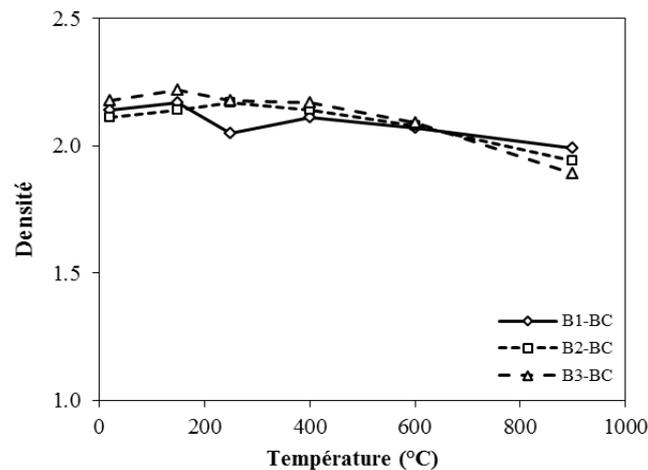
**Figure III.22.** Évolution de la densité apparente des bétons de granulats de brique concassée en fonction de la température.
