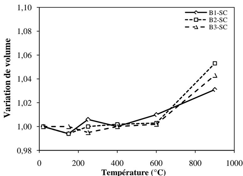
Figure III.17. Variation du volume apparent des bétons à base de sable concassé avec la température.
