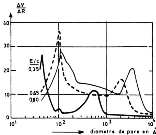
Figure I.7. Distribution porosimétrique d'un béton en fonction du rapport E/C [Malier, 1992].
