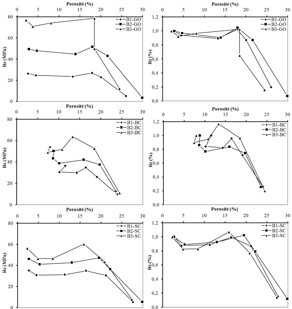
Figure IV.10. Evolution de la résistance en compression en fonction de la porosité.
