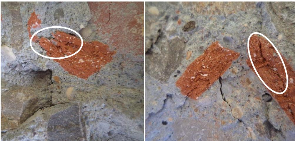
**Figure IV.7.** Faciès de rupture au sein du béton B3-BC.
