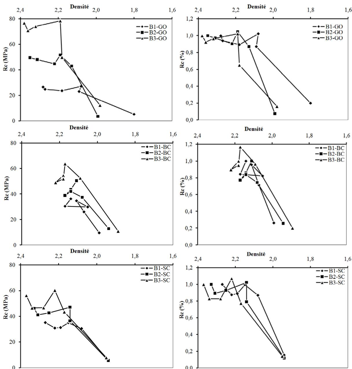
**Figure IV.11.** Evolution de la résistance en compression en fonction de la densité.
