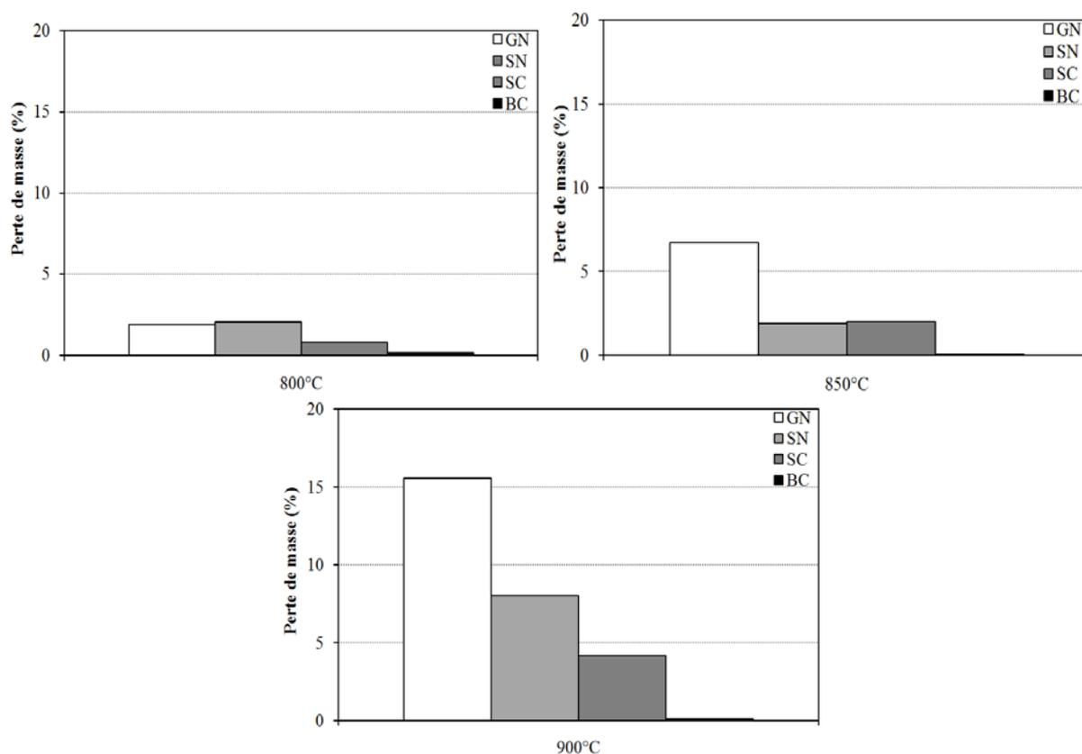
Figure III.3. Perte de masse des différents types de granulats à 700°C, 750°C, 800°C, 850°C et 900°C.
