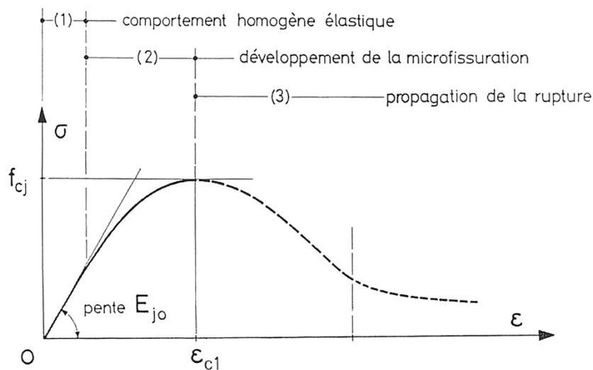
Figure I.9. Courbe contrainte-déformation en compression simple [Reynouard et Pijaudier-Cabot, 2005].
