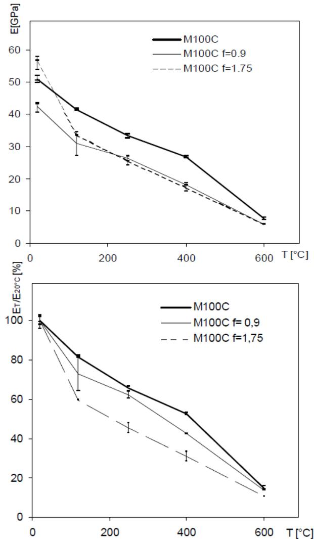
**Figure I.38.** Evolution des modules d'élasticité apparents et des modules d'élasticité apparents relatifs obtenus sur deux bétons fibrés et non fibrés [Hager, 2004].
