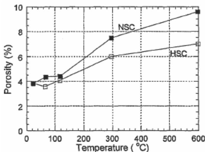
**Figure I.18.** Evolution de la porosité du béton avec la température [Noumowé et al., 1996].
