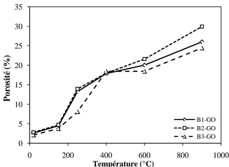
**Figure III.8.** Évolution de la porosité à l'eau des bétons de granulats ordinaires en fonction de la température.
