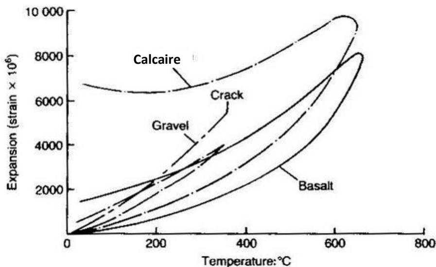
**Figure I.40.** Evolution de la dilatation thermique de différents types de roches avec la température [Khoury, 1992].
