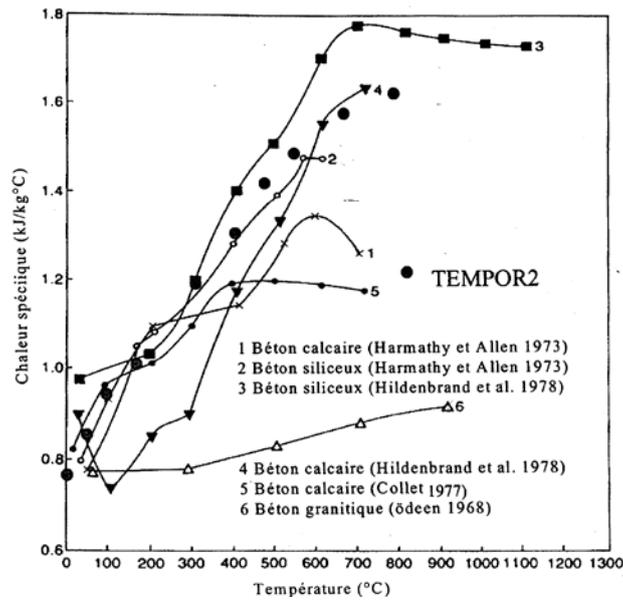
**Figure I.21.** Variation de la chaleur spécifique en fonction de la température [Bazant et Kaplan, 1996].
