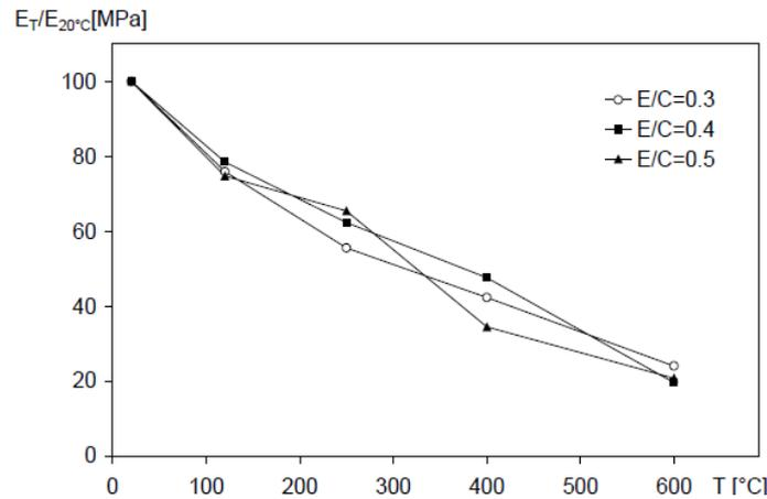
**Figure I.33.** Evolution des modules d'élasticité apparents et des modules d'élasticité apparents relatifs déterminés à chaud à différentes températures [Hager, 2004].
