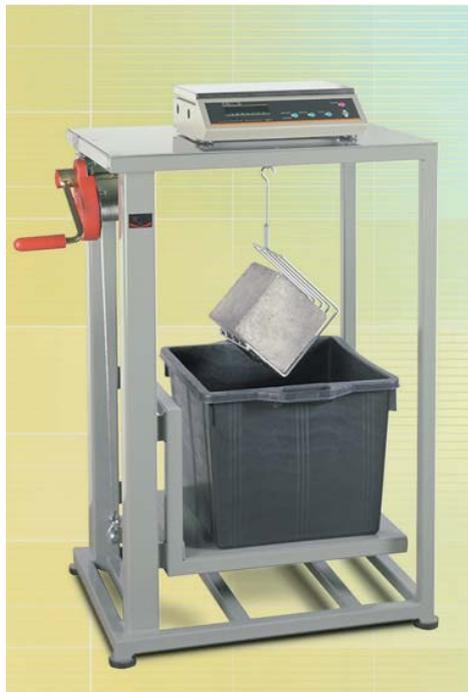
Figure II.14. Dispositif de la mesure de la porosité du béton.
