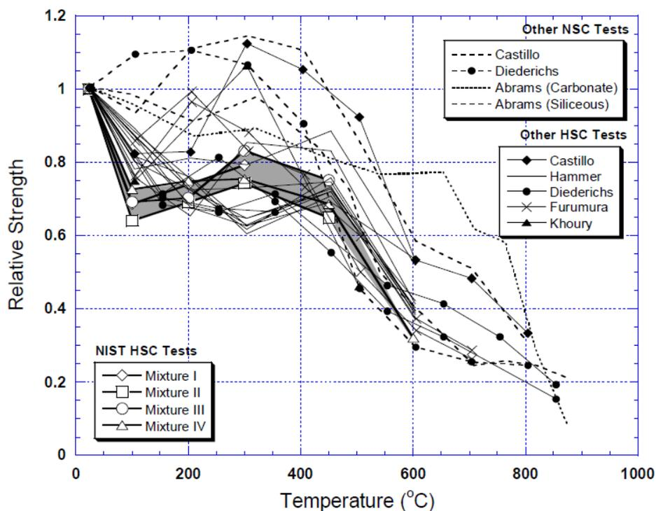
**Figure I.23.** Evolution de la résistance en compression relative des bétons avec la température [Phan et Carino, 2003].
