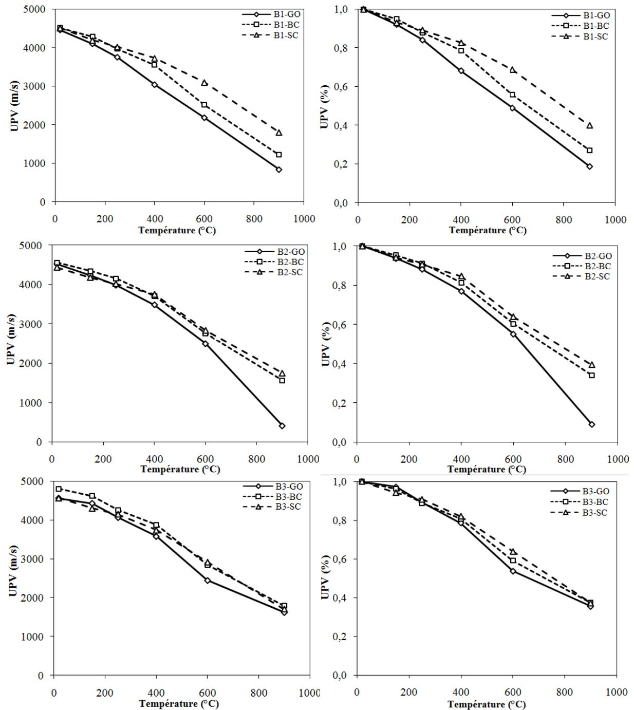
Figure IV.5. Effet de la température sur la vitesse des ondes soniques.
