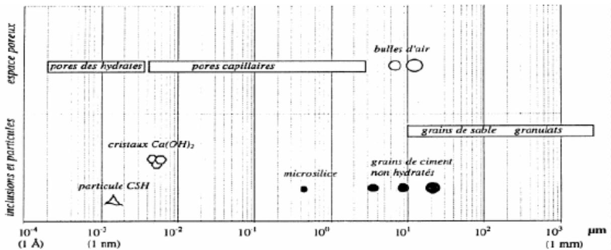
Figure I.6. Dimensions des pores et phases solides présentes dans le béton [Tsimbrovska, 1998].
