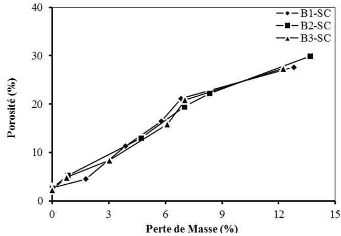
Figure IV.13. Evolution de la porosité en fonction de la perte de masse.
