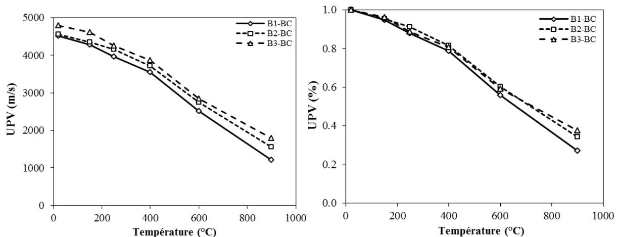
**Figure III.24.** Effet de la température sur la vitesse des ondes soniques des bétons de granulats de brique concassée.
