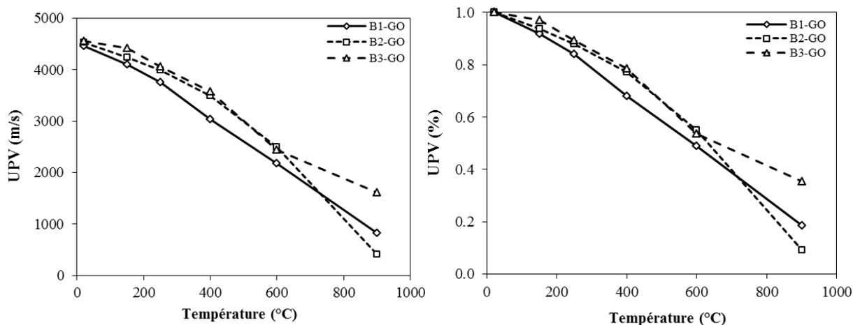
**Figure III.11.** Effet de la température sur la vitesse des ondes soniques des bétons de granulats ordinaires.
