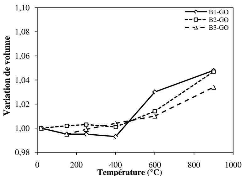
**Figure III.10.** Variation du volume des bétons de granulats ordinaires avec la température.
