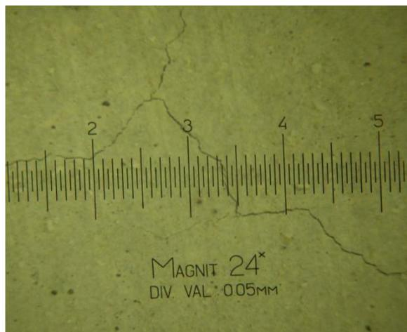
**Figure III.32.** Observation au microscope optique des fissures de faible ouverture du B3-GO après chauffage à 150°C.
