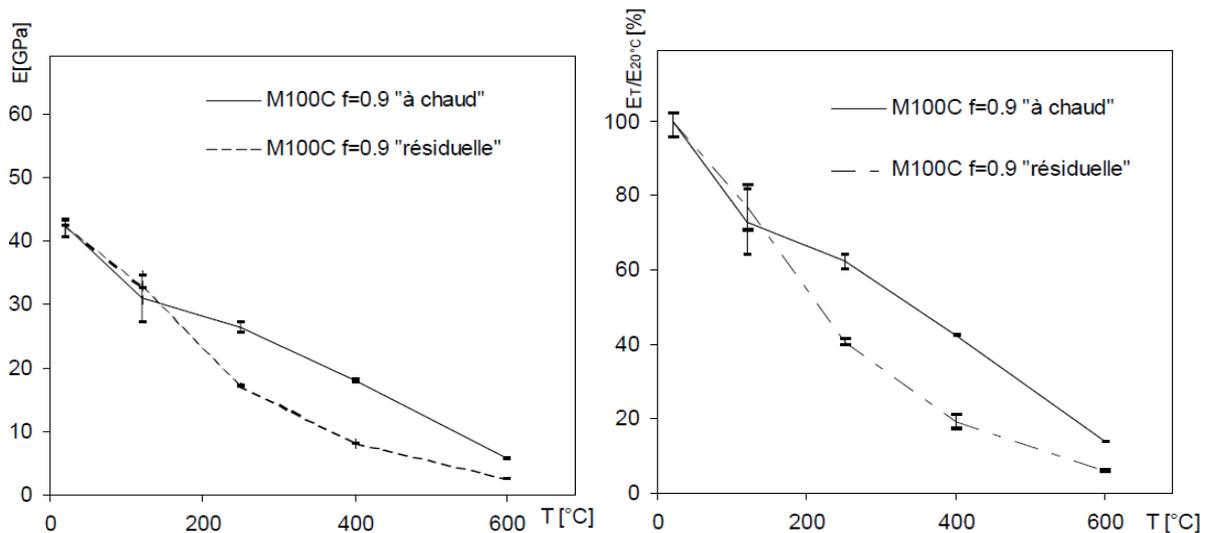
**Figure I.34.** Evolution du module d'élasticité obtenus à chaud et résiduelles [Hager, 2004].
