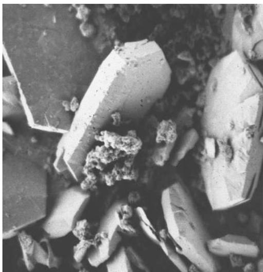
**Figure I.2.** Image de Portlandite obtenue au MEB [Mehta et Monteiro, 2006].
