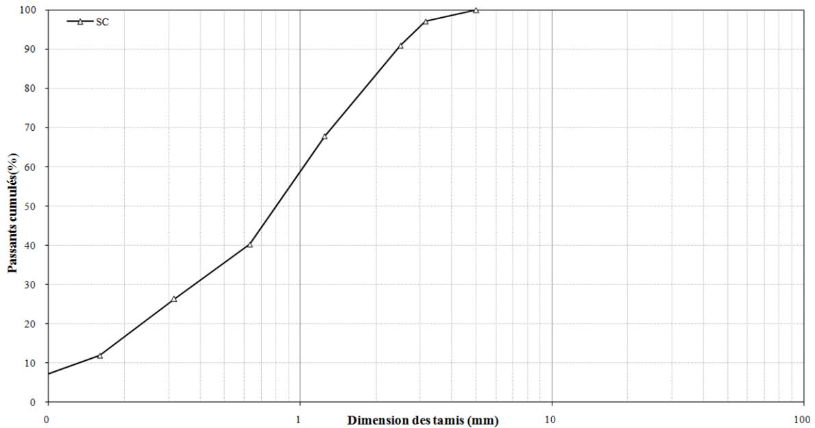
Figure II.4. Courbe granulométrique de du sable concassé.
