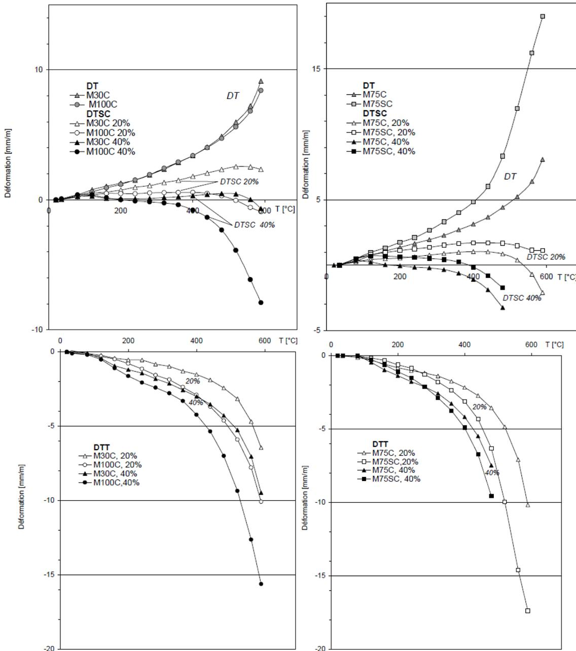
**Figure I.42.** Déformation thermique (DT), déformation thermique sous charge (DTSC) et déformation thermique transitoire (DTT) déterminées sur les bétons BO et BHP avec granulats calcaires, et BHP avec granulats silico-calcaires [Hager et Pimienta, 2004].
