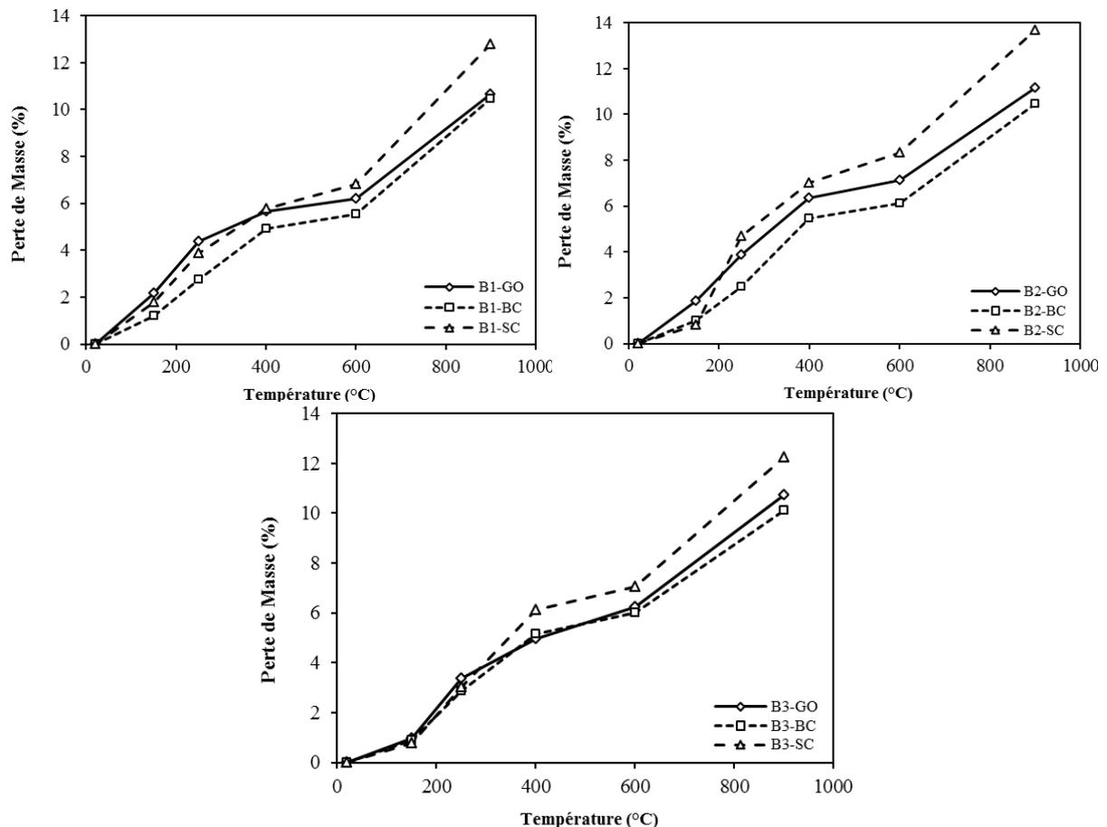
Figure IV.1. Évolution de la perte de masse des bétons en fonction de la température.
