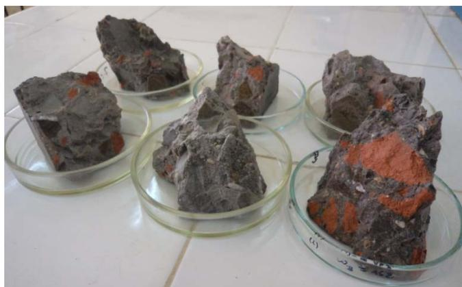
**Figure II.13.** Echantillons utilisés pour la mesure de la porosité à l'eau.
