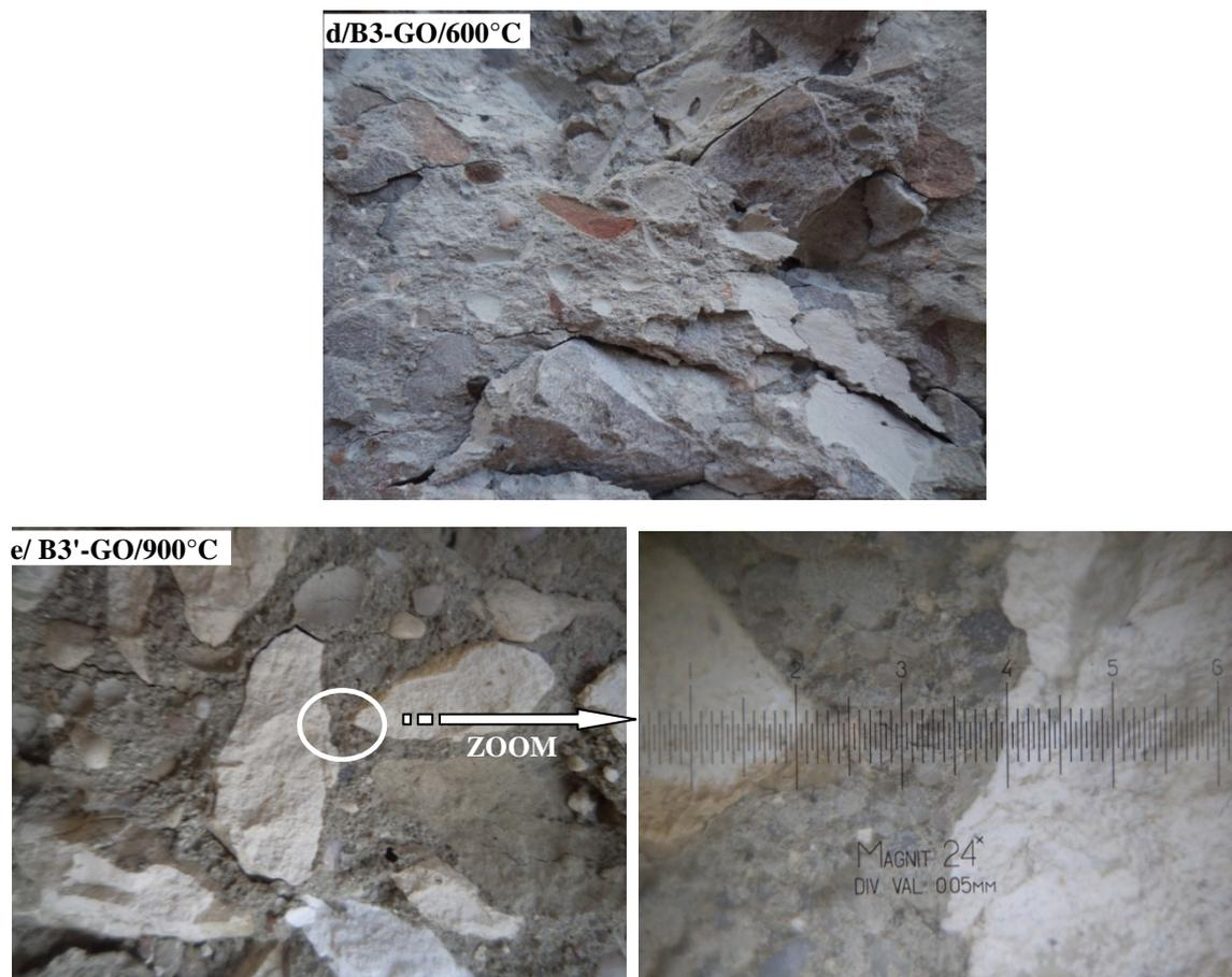
**Figure III.31.** L'aspect des fissurations après l'essai de compression des éprouvettes chauffées à 400°C, 600°C et 900°C.
