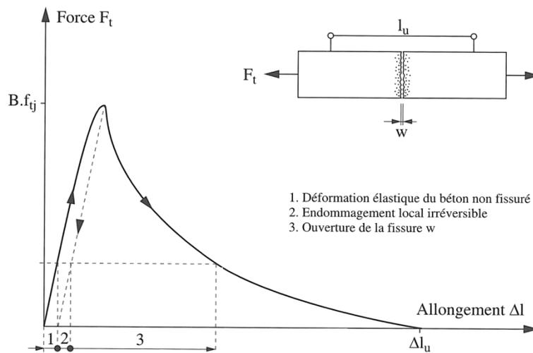
**Figure I.10.** Comportement du béton en traction simple [Reynouard et Pijaudier-Cabot, 2005].
