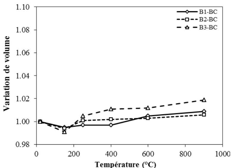
**Figure III.23.** Variation du volume apparent des bétons de granulats de brique concassée avec la température.
