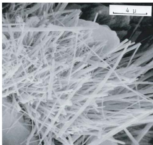
**Figure I.1.** Image de silicate de calcium hydraté obtenue au MEB
