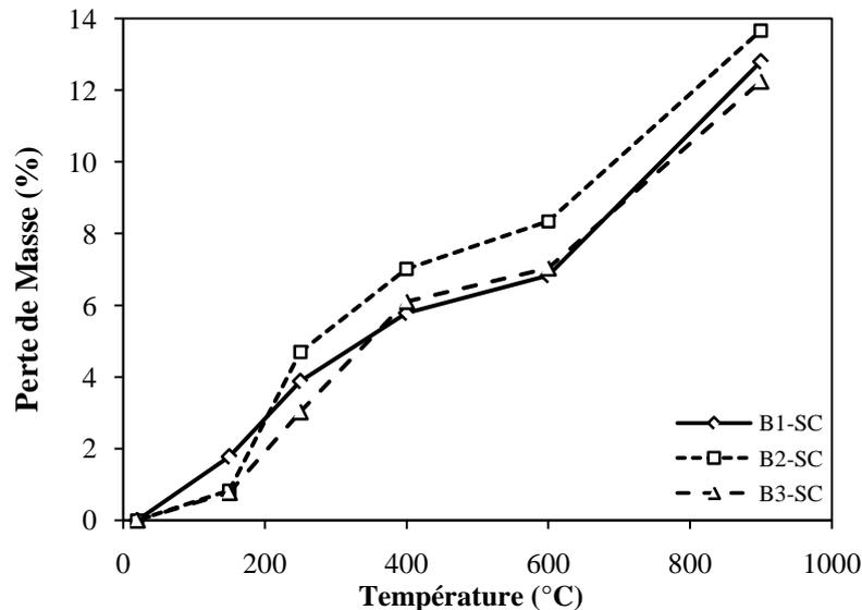
**Figure III.14.** Évolution de la perte de masse en fonction de la température pour les bétons B1-SC, B2-SC et B3-SC.
