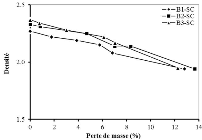
Figure IV.14. Evolution de la densité en fonction de la perte de masse.
