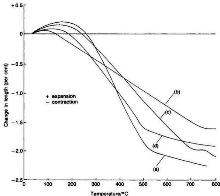
**Figure I.39.** Dilatation thermique de la pâte de ciment durcie selon quatre différents travaux [Bazant et Kaplan, 1996].
