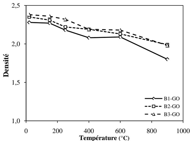
**Figure III.9.** Évolution de densité des bétons de granulats ordinaires en fonction de la température.
