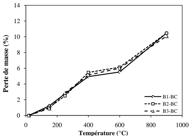
**Figure III.20.** Évolution de la perte de masse en fonction de la température pour les bétons B1-BC, B2-BC et B3-BC.
