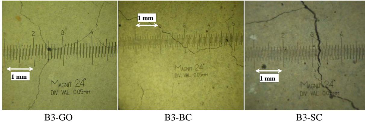
**Figure IV.8.** Clichés au microscope optique des bétons B3-GO, B3-BC et B3-SC après le chauffage à 250°C.
