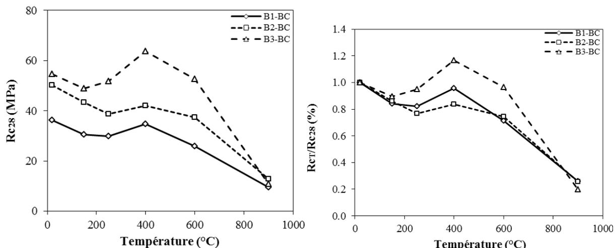
**Figure III.25.** Evolution de la résistance résiduelle et relative en compression des bétons de granulats de brique concassée en fonction de la température.
