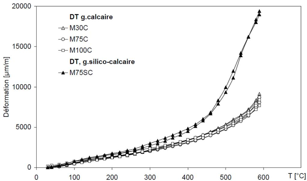
**Figure I.41.** Déformation thermique de quatre différents bétons confectionnés avec des granulats calcaires et silico-calcaires [Hager, 2004].
