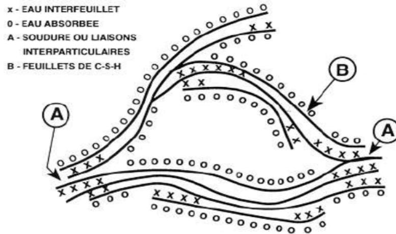
Figure I.4. Représentation schématique de la microstructure du gel de CSH [Reynouard et Pijaudier-Cabot, 2005].
