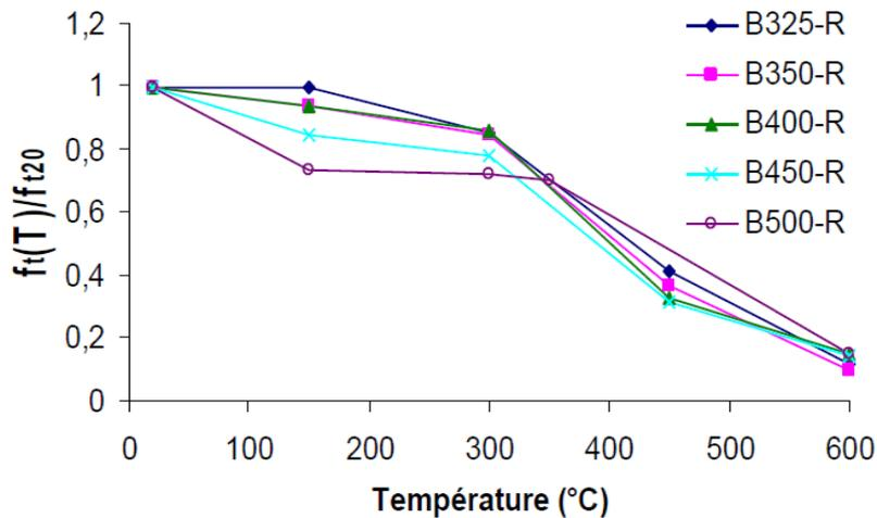
**Figure I.30.** Evolution de la résistance à la traction du béton mesurée par essai de fendage après refroidissement [Kanema, 2007].
