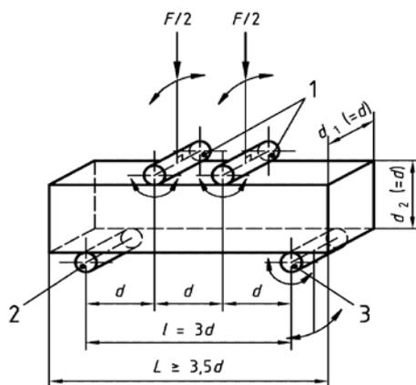
Figure II.11. Epreuve mise en place dans l’appareil pour déterminer la résistance en flexion.
