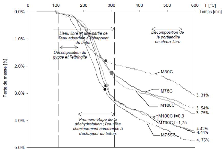
Figure I.17. Perte de masse des bétons déterminées durant l'échauffement [Hager, 2004].
