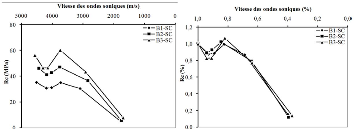
Figure IV.12. Evolution de la résistance en compression en fonction de la vitesse des ondes soniques.
