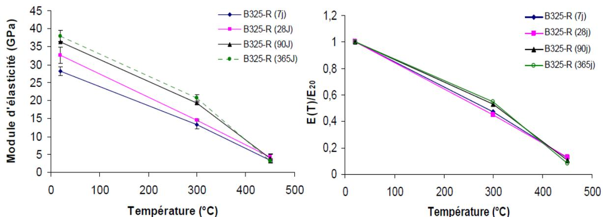
**Figure I.37.** Evolution du module d'élasticité résiduel du béton avec la température et à différents âges (7, 28, 90, et 365 jours) [Kanema, 2007].
