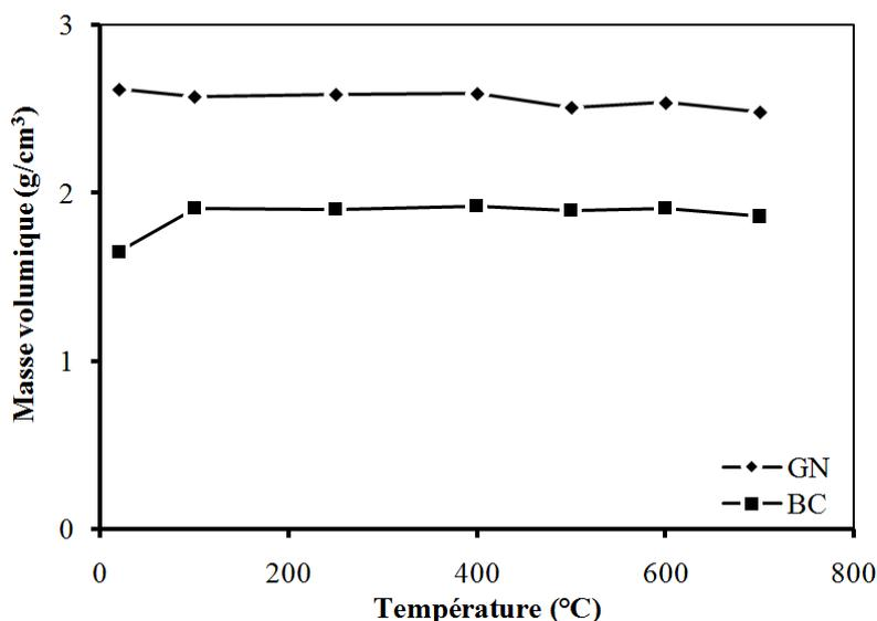
**Figure III.5.** Evolution de la masse volumique des granulats avec température.
