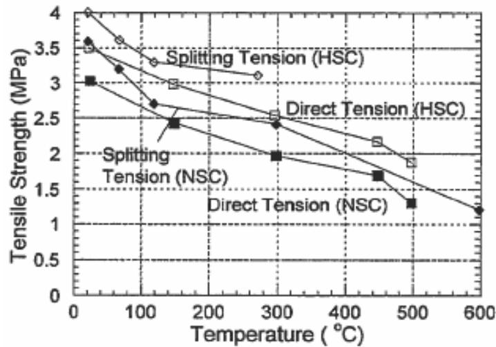
**Figure I.29.** Evolution de la résistance résiduelle en traction avec la température [Noumowe et al., 1996].
