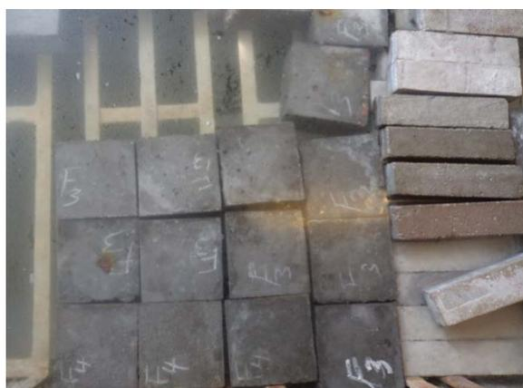
**Figure II.5.** Conservation des éprouvettes immergées dans l'eau.
