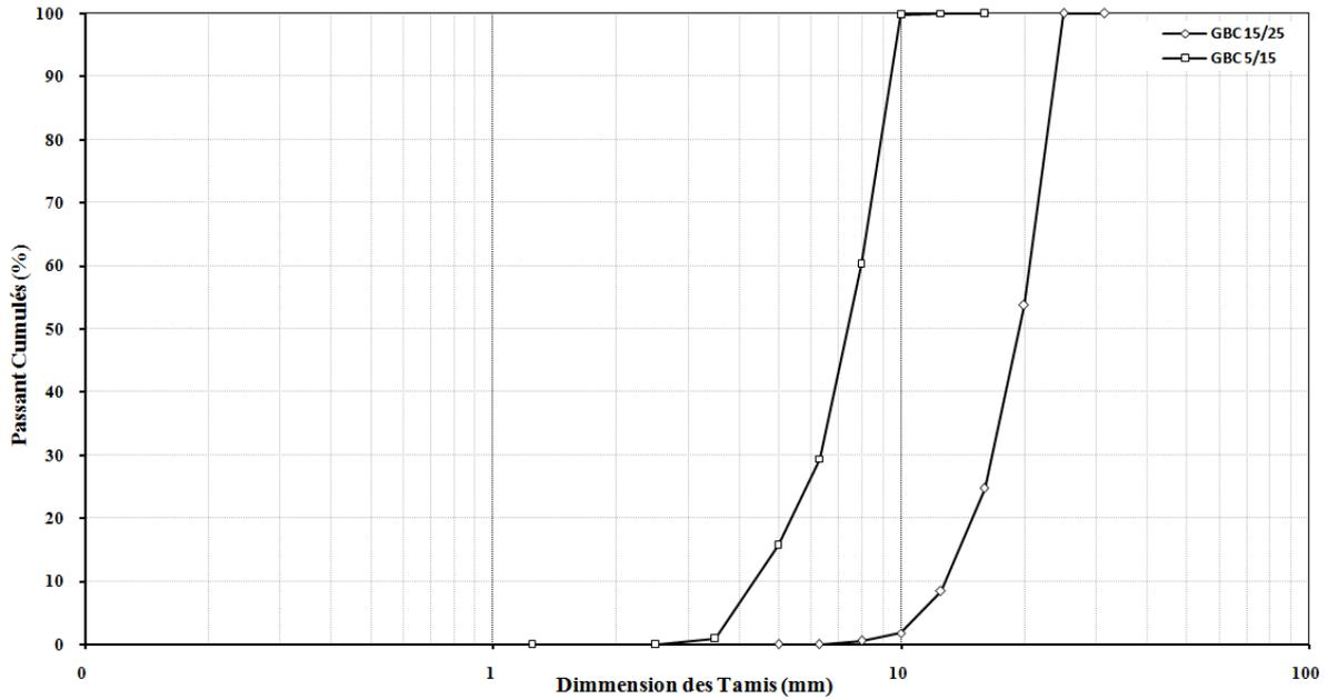
Figure II.3. Courbe granulométrique de granulats de brique concassée.
