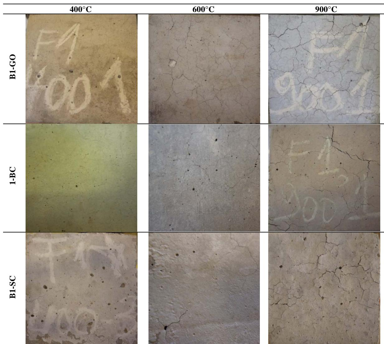
**Figure III.26.** Observations à l'œil nu de l'évolution de la dégradation des bétons B1-GO, B1-BC et B1-SC après les cycles de chauffage de 400°C, 600°C et 900°C.
