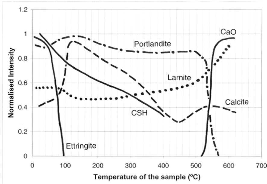
**Figure I.13.** Evolution des quantités de phase d'une pâte de ciment durcie au cours de l'échauffement. [Alonso et al., 2003-a].
