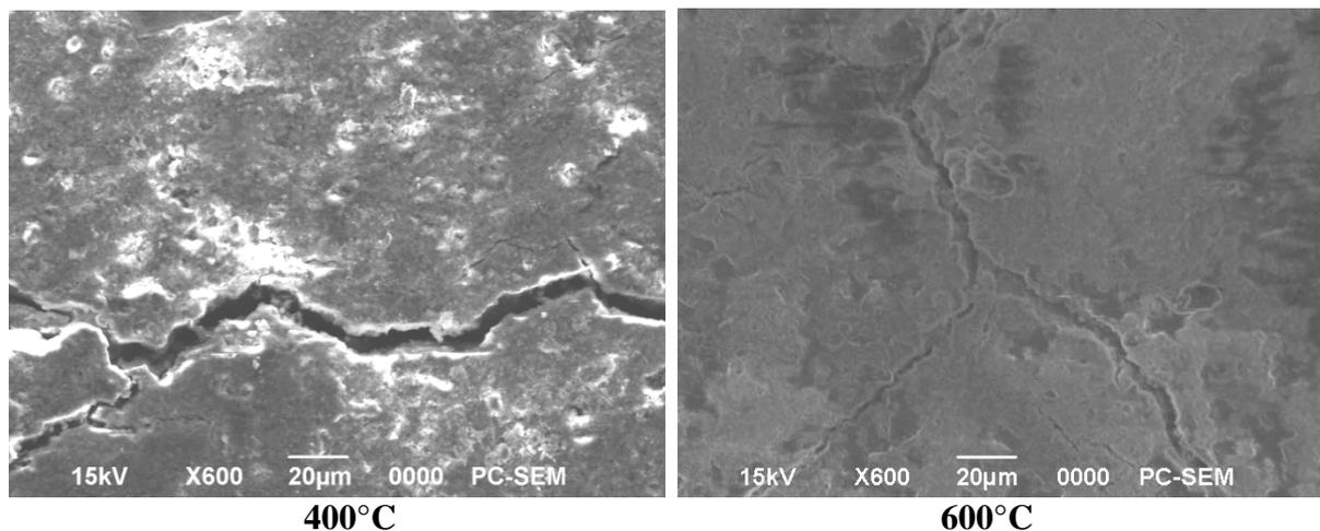
**Figure III.33.** Observations au MEB d'échantillons de B3-BC chauffés à 150°C, 250°C, 400°C et 600°C.
