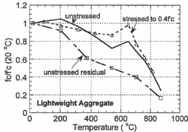
**Figure I.26.** Influence des conditions de la réalisation des essais sur la résistance en compression [Abrams, 1971].
