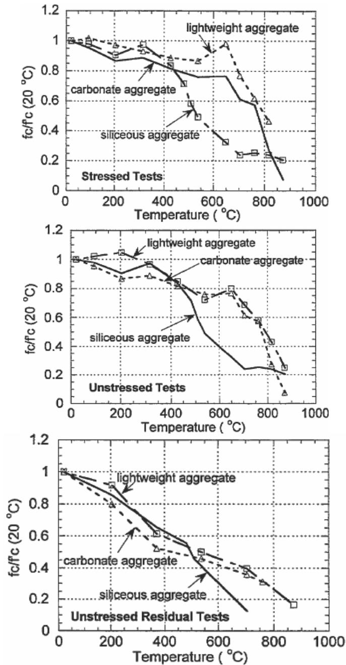
**Figure I.24.** Influence du type de granulats sur l'évolution de la résistance en compression du béton avec la température [Abrams, 1971].
