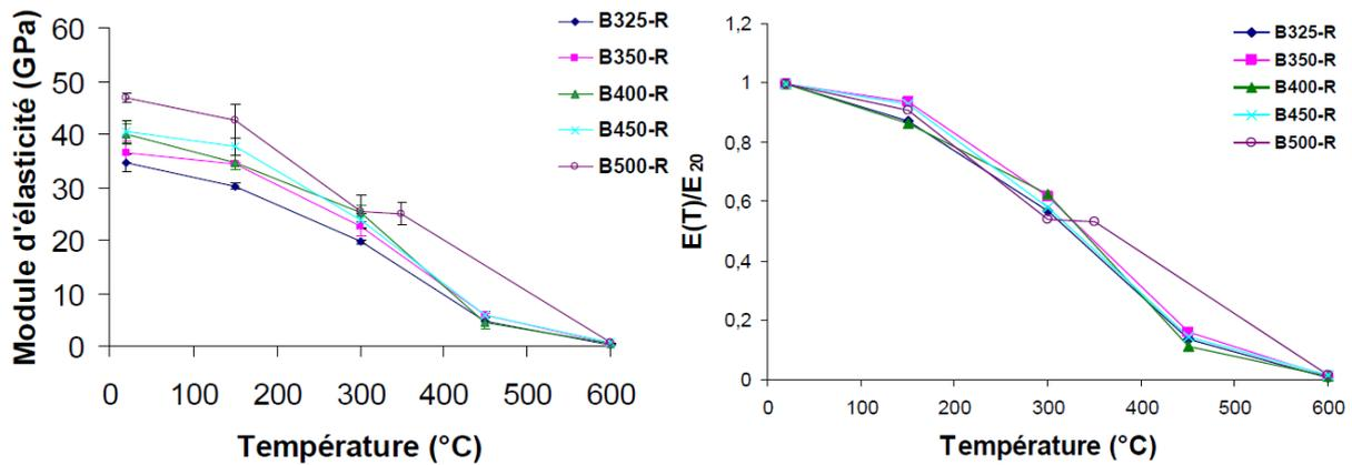
**Figure I.32.** Evolution des modules d'élasticité résiduels et des modules d'élasticité résiduels relatifs à différentes températures [Kanema et al., 2005].
