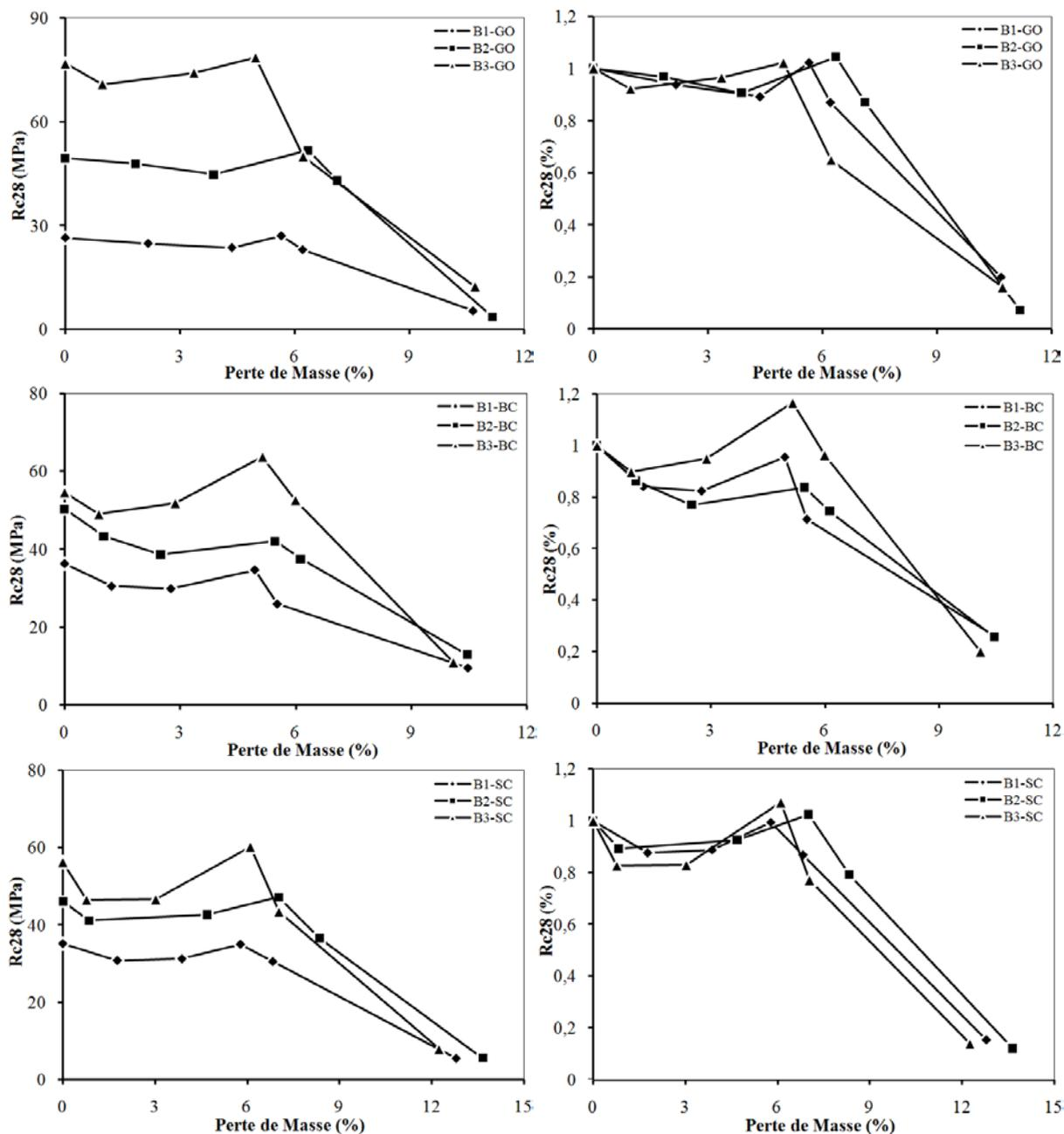
Figure IV.9. Evolution de la résistance en compression en fonction de la perte de masse.
