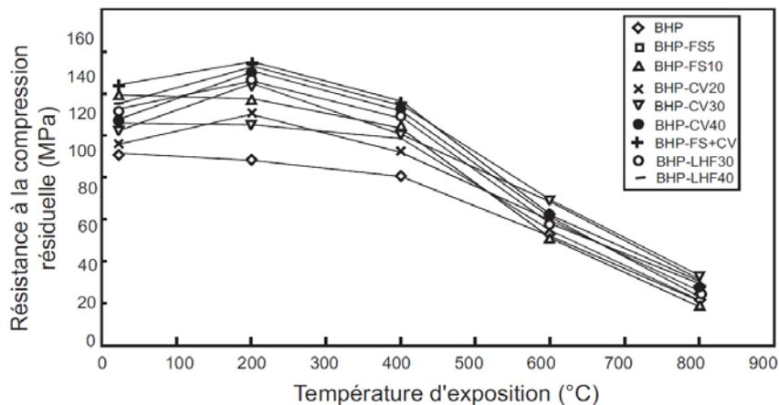
BHP : béton à haute performance de référence, FS : fumée de silice, CV : cendres volantes, LHF : laitier de haut-fourneau
