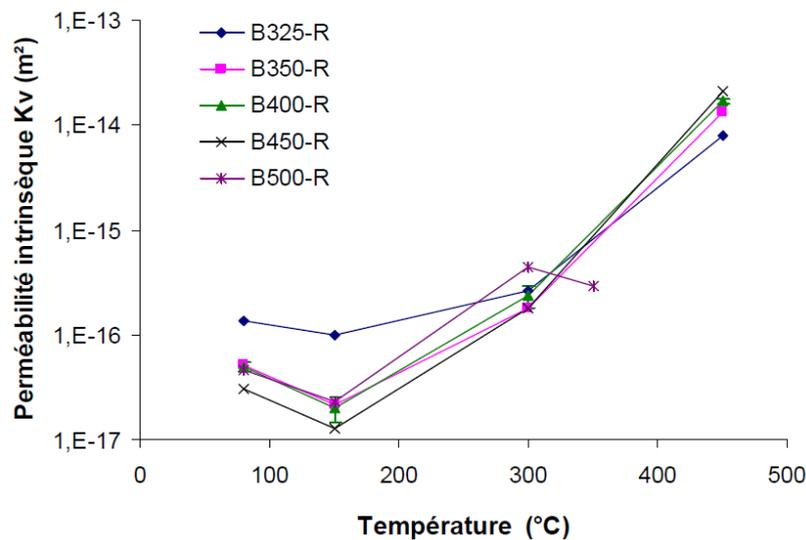
**Figure I.19.** Evolution de la perméabilité intrinsèque résiduelle des bétons en fonction de la température [Kanema et al., 2005].
