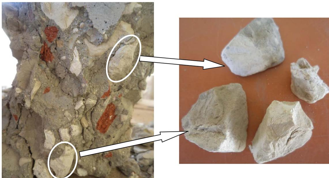
**Figure III.27.** Décarbonation des granulats calcaires après le cycle de 900°C.
