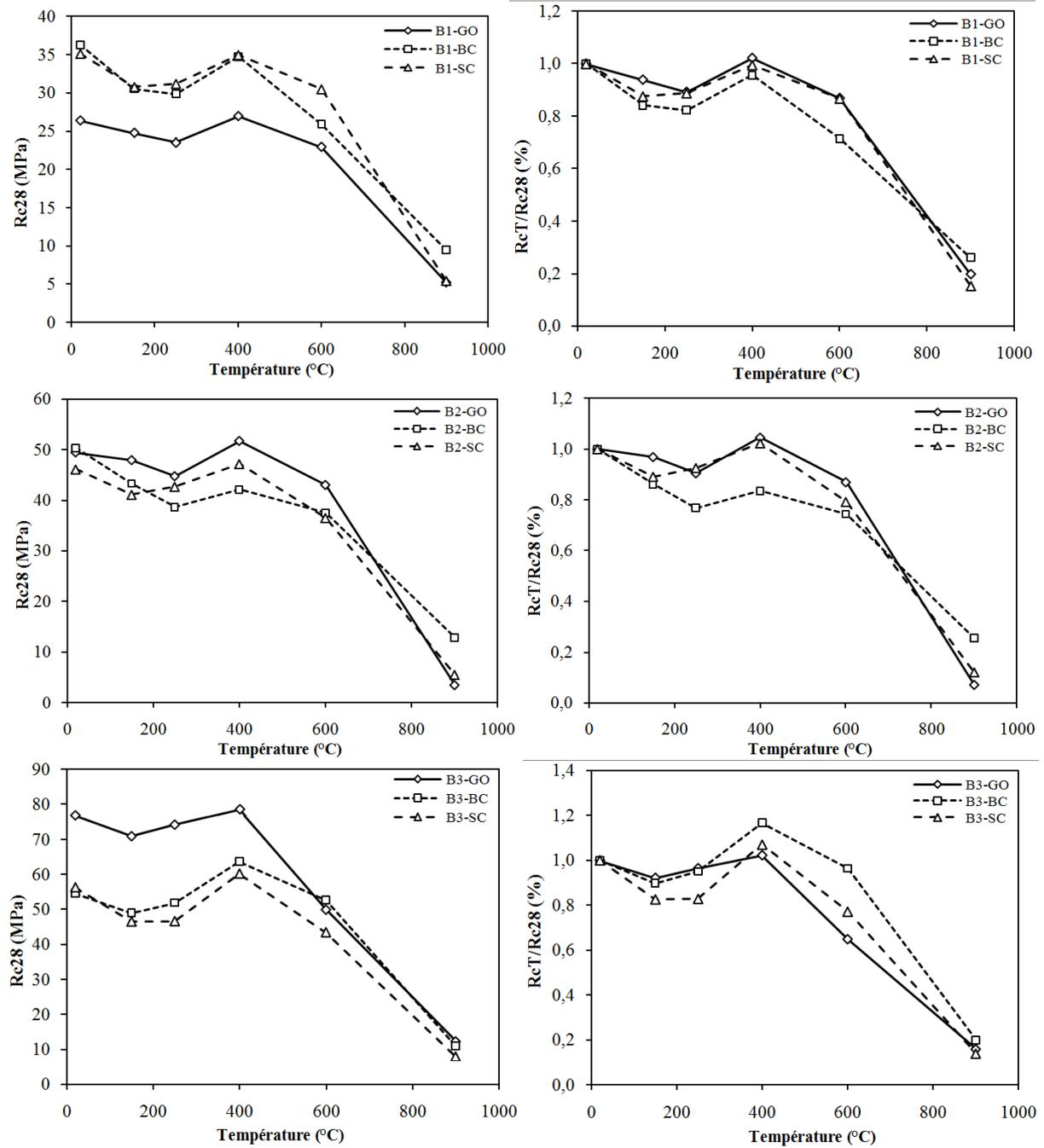
Figure IV.6. Evolution de la résistance en compression avec la température.
