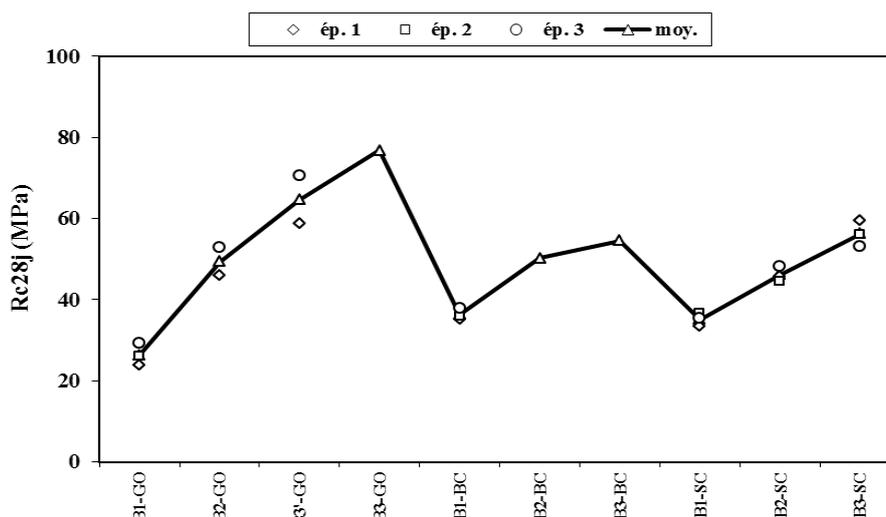
**Figure II.9.** Résistance en compression moyenne à 28 jours des bétons de l'étude.
