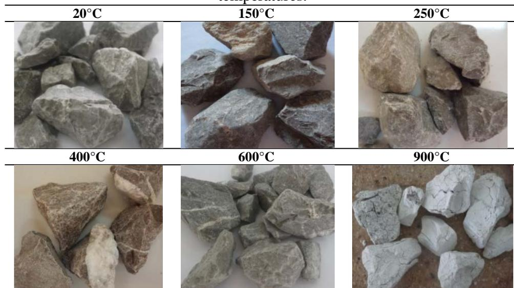
La formation de la couche blanche sur les surfaces des granulats calcaires est la conséquence de la décarbonatation des calcaires, la calcite ( $\text{CaCO}_3$ ) se transformant en chaux ( $\text{CaO}$ ) suite au départ de  $\text{CO}_2$  [Xing et al., 2011], [Nyry et al., 2013], [Xing et al., 2013]. Après refroidissement, le  $\text{CaO}$  réagit avec l'humidité de l'air et se transforme en portlandite  $\text{Ca(OH)}_2$  [Nyry et al., 2012].
