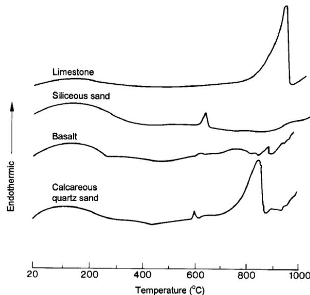
**Figure I.15.** Courbes ATD de quatre types de granulats (10°C/min) [Schrefler et al., 2003].
