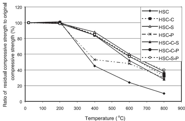
HSC : BHP, HSC-C : BHP avec fibres de carbone, HSC-S : BHP avec fibres métalliques, HSC-P : BHP avec fibres polypropylène
