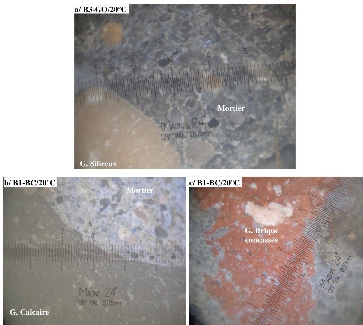
**Figure III.30.** Liaison entre les différents granulats et la pâte de ciment.
