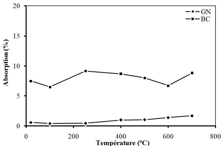
Figure III.6. Evolution du coefficient d'absorption des granulats avec température.
