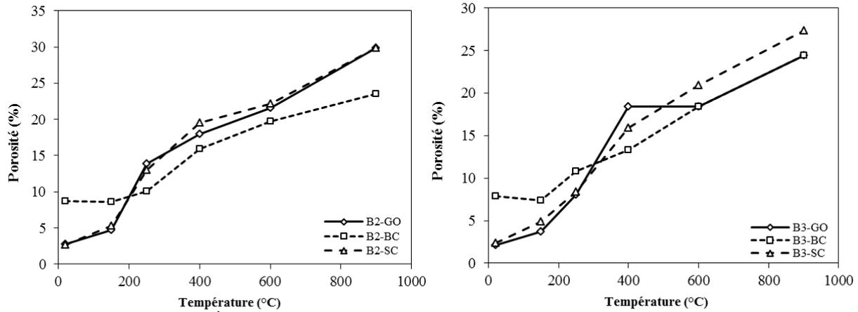
Figure IV.2. Évolution de la porosité à l'eau des différents types de bétons.
