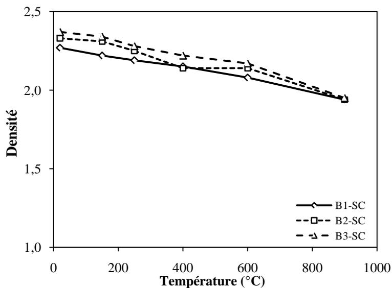
**Figure III.16.** Évolution de densité des bétons à base de sable concassé en fonction de la température.
