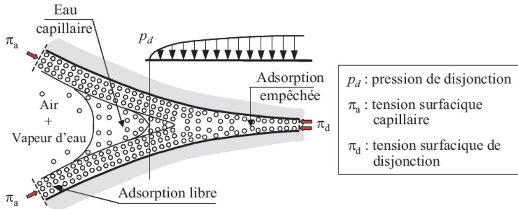
Figure I.5. Schéma de principe de la zone d'adsorption empêchée [Reynouard et Pijaudier-Cabot, 2005].
