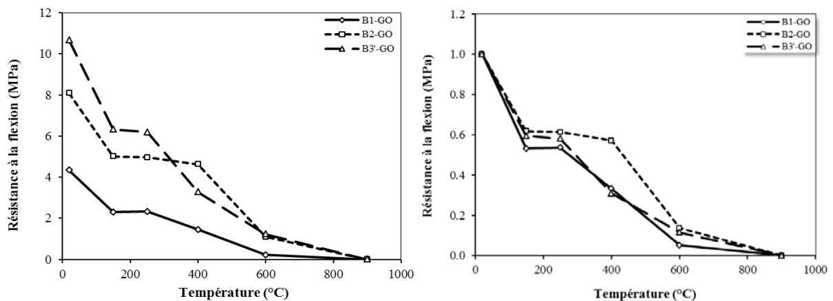
**Figure III.13.** Évolution de la résistance à la flexion des bétons de granulats ordinaires en fonction de la température.
