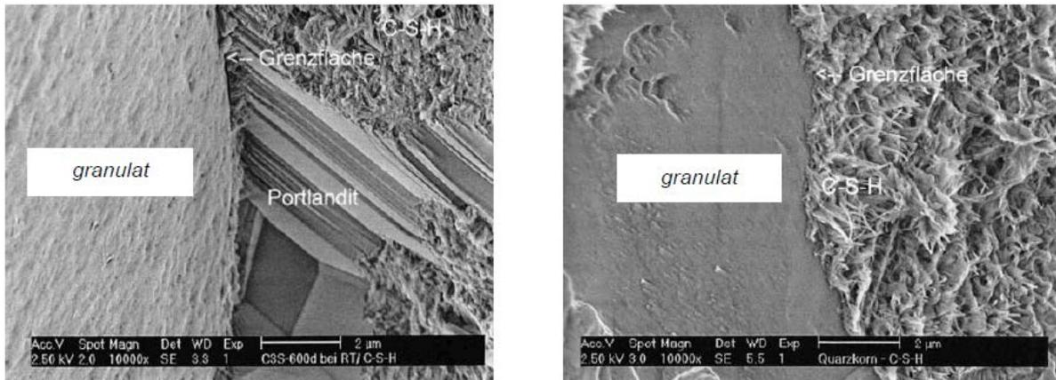
**Figure I.8.** Microstructure de la zone de contact entre la pâte de ciment et le granulats, à gauche : Béton sans fumée de silice - à droite : Béton avec fumée de silice [Stark et Wicht, 2001].
