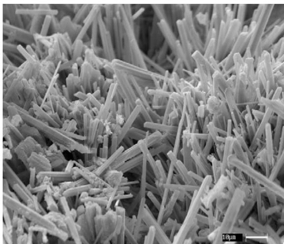
**Figure I.3.** Image des cristaux d'ettringite obtenue au MEB [Mehta et Monteiro, 2006].
