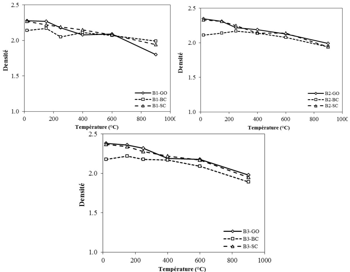
**Figure IV.3.** Évolution de la densité des différents bétons en fonction de la température.
