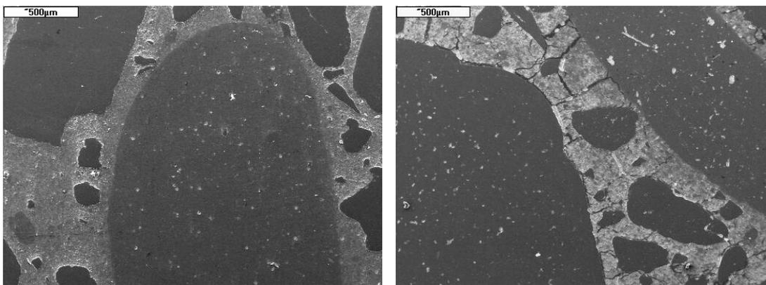
**Figure I.16.** Comparaison de la structure d'un BHP avant et après l'échauffement à 600°C.
