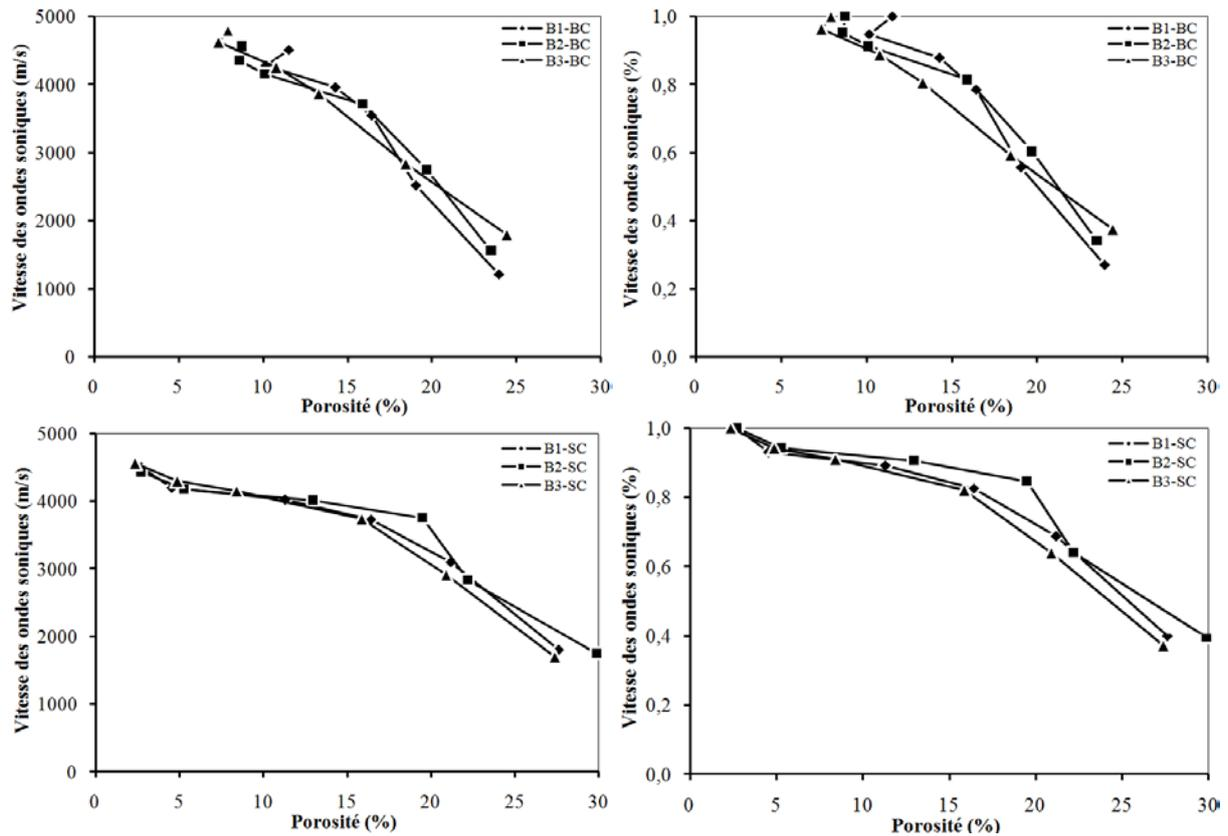
Figure IV.15. Evolution de la vitesse des ondes soniques en fonction de la porosité.
