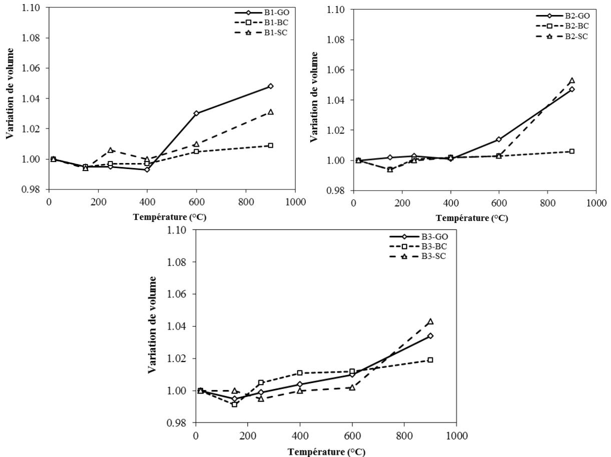
Figure IV.4. Variation du volume des différents bétons.
