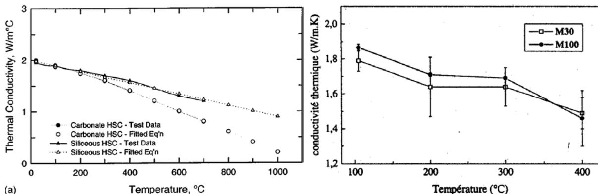
**Figure I.20.** Evolution de la conductivité thermique de différents bétons avec la température. A gauche, l'effet de type des agrégats [Kodur et Sultan, 2003]. À droite, l'effet de type du béton [Kalifa et Tsimbrovska, 1998].
