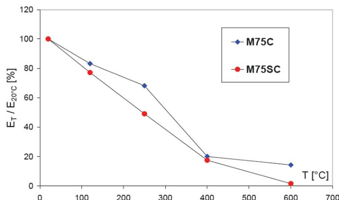
**Figure I.36.** Evolution avec la température du module d'élasticité relatif d'un béton en fonction de la nature du granulat (calcaire et silico-calcaires) [Pimienta et Hager, 2002].
