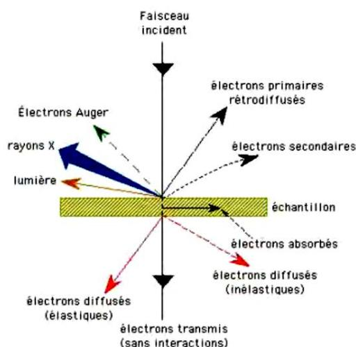
**Figure II.18.** Ensemble des radiations pouvant être émises lors de l'interaction entre le faisceau et l'échantillon [Fares, 2009].
