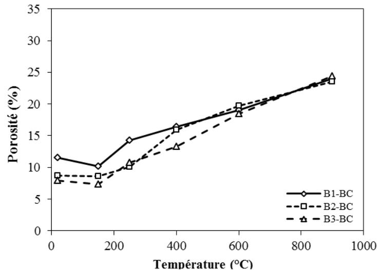
**Figure III.21.** Évolution de la porosité à l'eau des bétons de granulats de brique concassée en fonction de la température.
