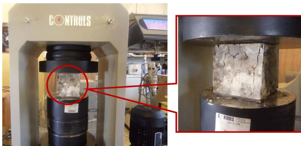
**Figure II.10.** Epreuve mise en place sur la presse hydraulique pour déterminer la résistance en compression.
