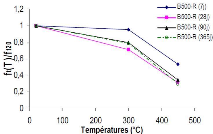
**Figure I.31.** Evolution de la résistance à la traction résiduelle et relative du béton âgé de 7, 28, 90 et 365 jours soumis à différentes températures [Kanema, 2007].
