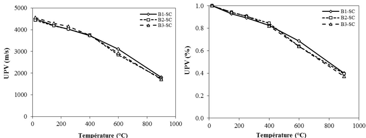
**Figure III.18.** Effet de la température sur la vitesse des ondes soniques des bétons à base de sable concassé.
