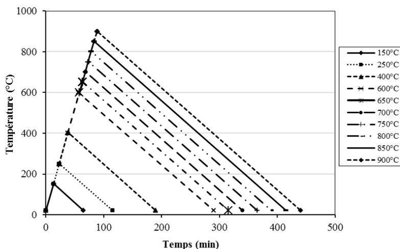
Figure II.20. Courbes des différents cycles de chauffage.
