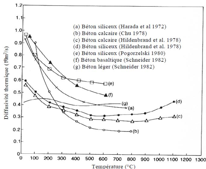
**Figure I.22.** Variation de la diffusivité thermique de différents types de béton avec la température [Bazant et Kaplan, 1996].
