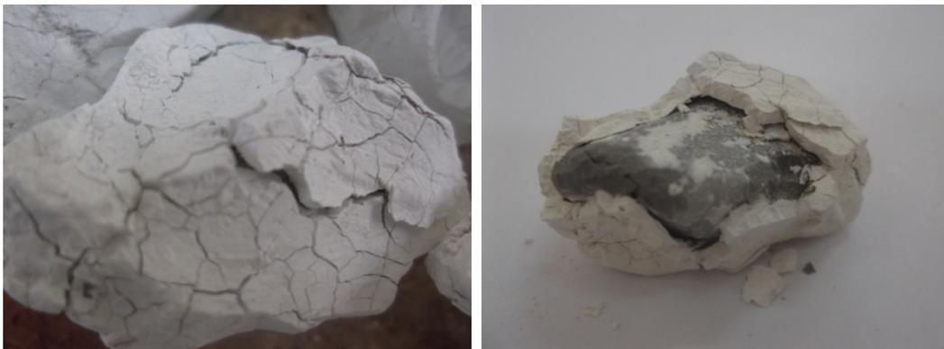
**Figure III.1.** État des granulats calcaires après chauffage à  $900^\circ\text{C}$ .
