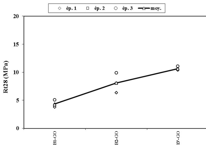
Figure II.12. Résistance à la flexion moyenne à 28 jours des B1-GO, B2-GO et B3'-GO.
