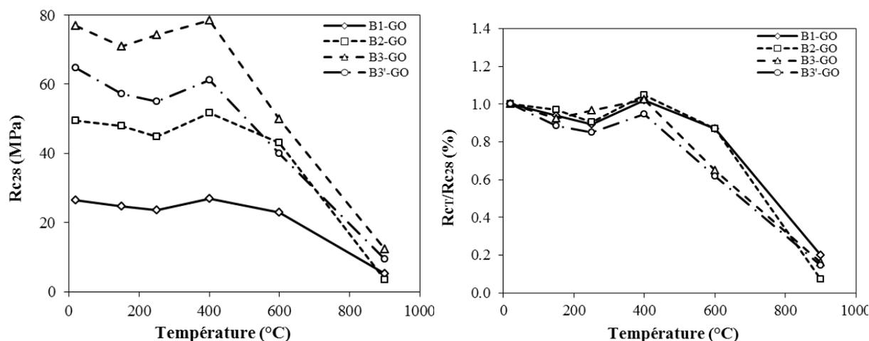
**Figure III.12.** Evolution de la résistance résiduelle et relative en compression des bétons de granulats ordinaires en fonction de la température.
