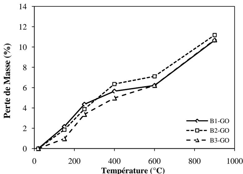
**Figure III.7.** Évolution de la perte de masse en fonction de la température pour les bétons B1-GO, B2-GO et B3-GO.
