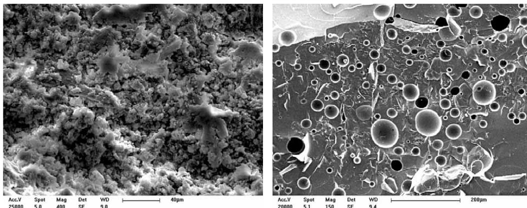
**Figure I.14.** Observation au Microscope Électronique à Balayage de deux échantillons de pâte de ciment, à droite : pâte de ciment à température ambiante avec un grossissement de 400, à gauche : pâte de ciment à 1000°C avec un grossissement de 150 [Divet et al, 2005].
