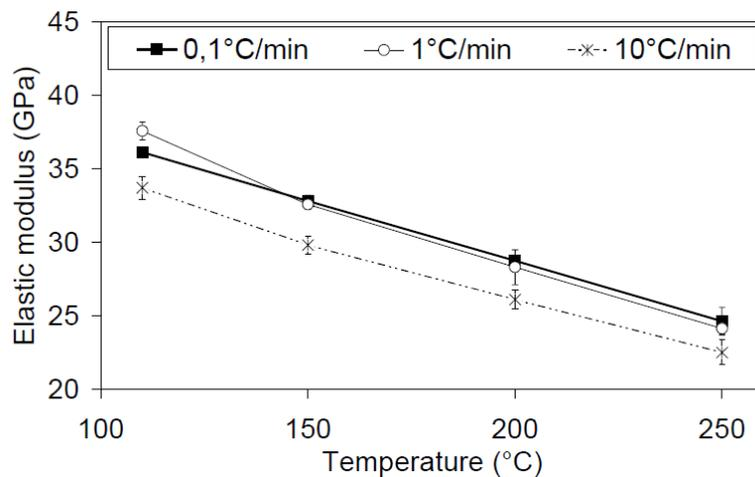
**Figure I.35.** Module d'élasticité résiduel du béton chauffé à une vitesse de 0,1°C/min, 1°C/min et 10°C/min à différentes températures [Gallé et al., 2003].
