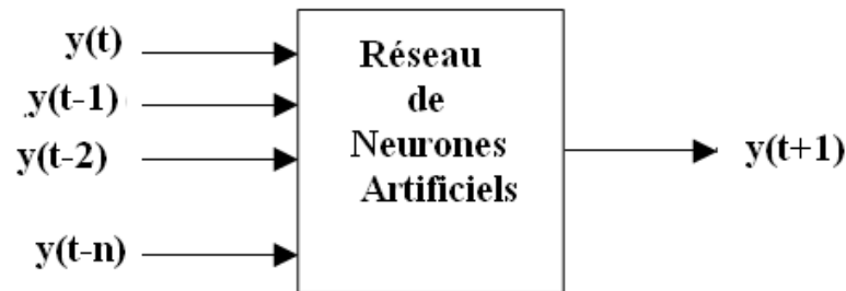
Figure 42 : Réseau de neurones artificiels pour des applications de prédiction avec des entrées temporisées
