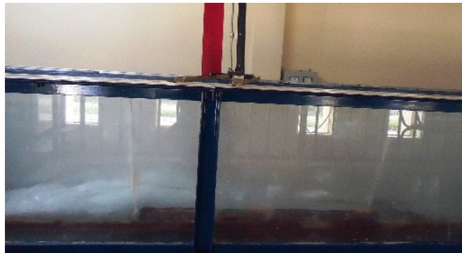
Figure 1.13: photographie d'un ressaut hydraulique forcé type -A par marche F_1 = 8,96 ; s = 17 cm; L_j = 164 cm; h_2 = 20,8 cm
