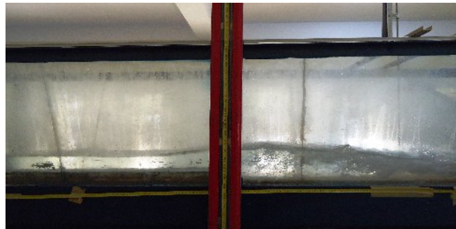
Figure 1.10 : photographie d'un ressaut hydraulique contrôlé par marche positive F_1 = 8,87 ; s = 17 cm; L_j = 164 cm; h_2 = 20,8 cm
