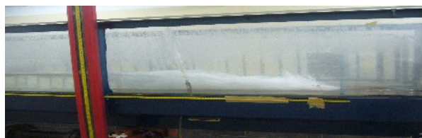
Figure 1.12: photographie d'un ressaut hydraulique contrôlé à pente négative F_1 = 9,05 ; s = 3 cm; L_j = 154 cm; h_2 = 18,4 cm; \tan(\alpha) = -0,01
