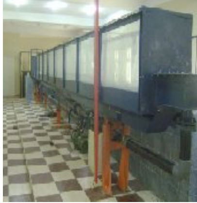
Figure 1.1 : Photographie du canal de mesure utilisé (vu latérale).
