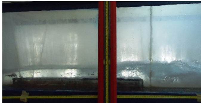
Figure 1.11: photographie d'un ressaut hydraulique contrôlé par marche positive F_1 = 8,96 ; s = 17 cm; L_j = 164 cm; h_2 = 20,8 cm
