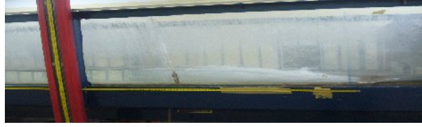
Figure 1.13 : photographie d'un ressaut hydraulique contrôlé à pente nulle F_1 = 6,63 ; s = 7 cm; L_j = 110 cm; h_2 = 13,7 cm ; \tan(\alpha) = 0
