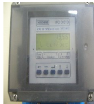
Figure 1.8 : a) photographie du convertisseur du débitmètre électromagnétique b) photographie de l'écran d'affichage des débits
