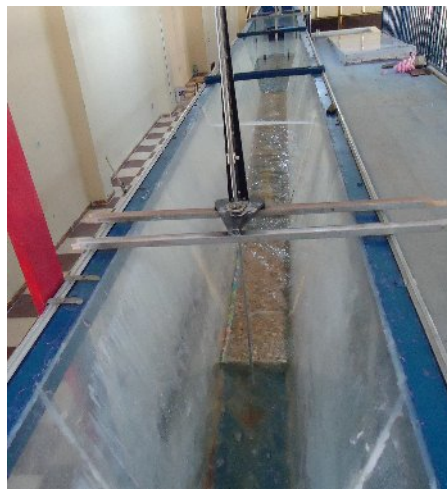
Figure 1.7 : Mesure de la profondeur d'eau par pointe limnimétrique.
