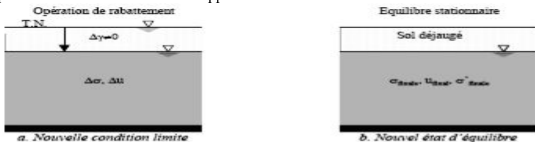
Figure V.2. Réponse d'un massif de sol après le rabattement de la nappe.
