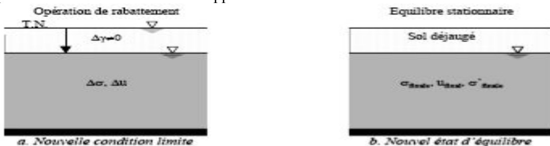
Figure V.2. Réponse d'un massif de sol après le rabattement de la nappe.
