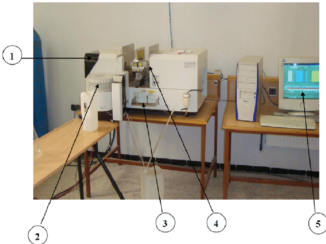
Figure IV.1 : Spectrophotomètre d'Absorption Atomique de type Shimadzu AA 6200
