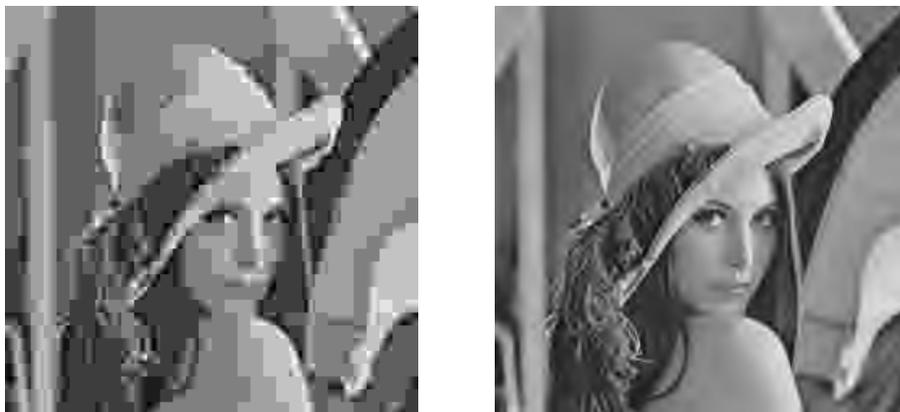
Figure 1.3 : Résultats de l'image Lena reconstruite à 0.2 bpp, a) par la norme JPEG avec PSNR =23.4 dB ; b) par la norme JPEG2000, avec PSNR=28.7 dB.
