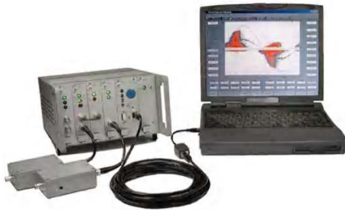
Figure III.5 : Dispositif de détection de DP (unité d'acquisition et accessoires)
