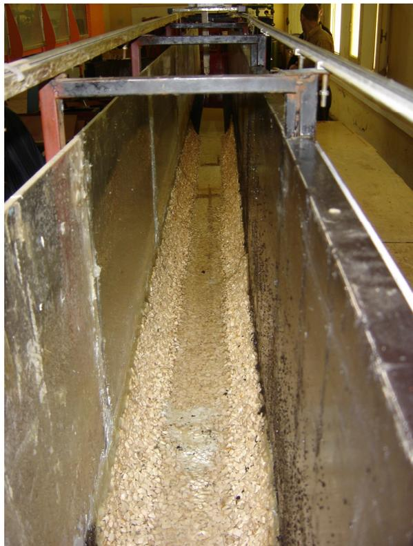
**Photo 2.10** : Echantillon de grains de gravier de rugosité absolue  $\varepsilon=4,30\text{ mm}$ .
