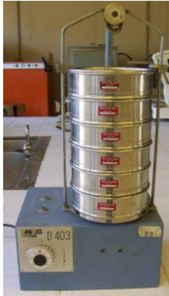
Photo 5.6 : Une série de tamis placés sur un vibreur.
