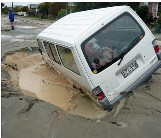
**Figure 1.25 :** Une camionnette qui malheureusement conduit dans un trou causé par la liquéfaction, du Nord de New Brighton, lors du séisme de Christchurch (2011)
