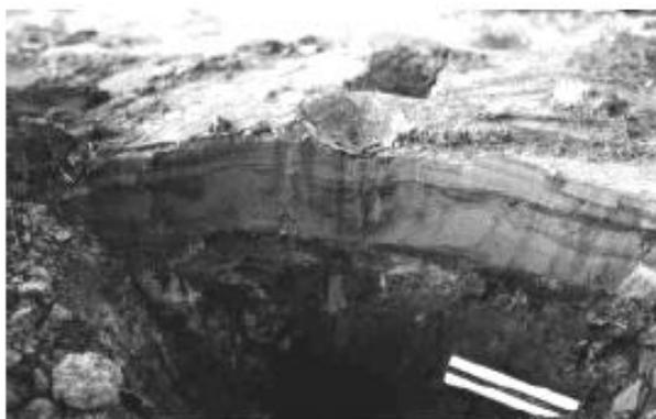
*Figure 1.7: Ebullition de sable au site de Wildlife (d'après le Earthquake Engineering Research Center, University of California, Berkeley; Elgamal et al, 2001)*
