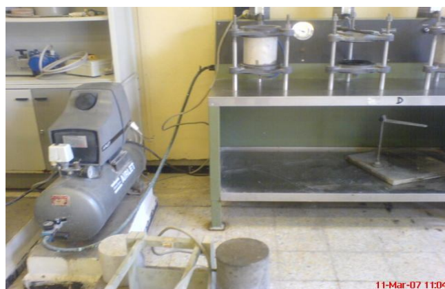
Photo 3-12 : Essai de perméabilité.
