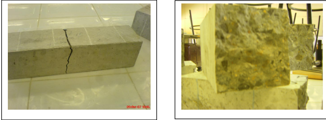
Photo 4-2 : rupture des éprouvettes « essais de flexion »
