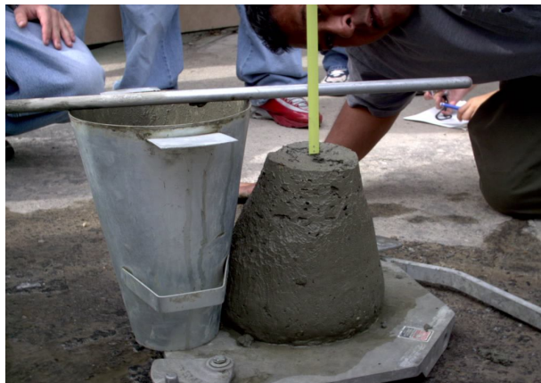
Photo 3.7 : Essai de Slump-Test
