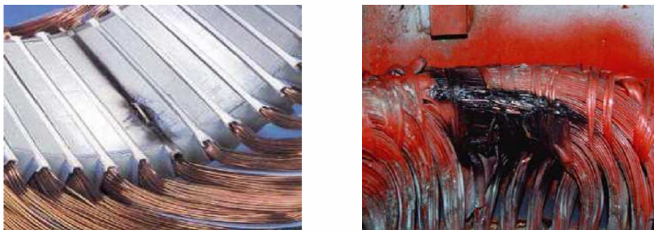
Figure 1.6: Exemples de dégâts dus au défaut de court-circuit statorique d'un moteur asynchrone
