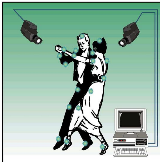
Figure1.6 : Principe de fonctionnement des systèmes optiques
