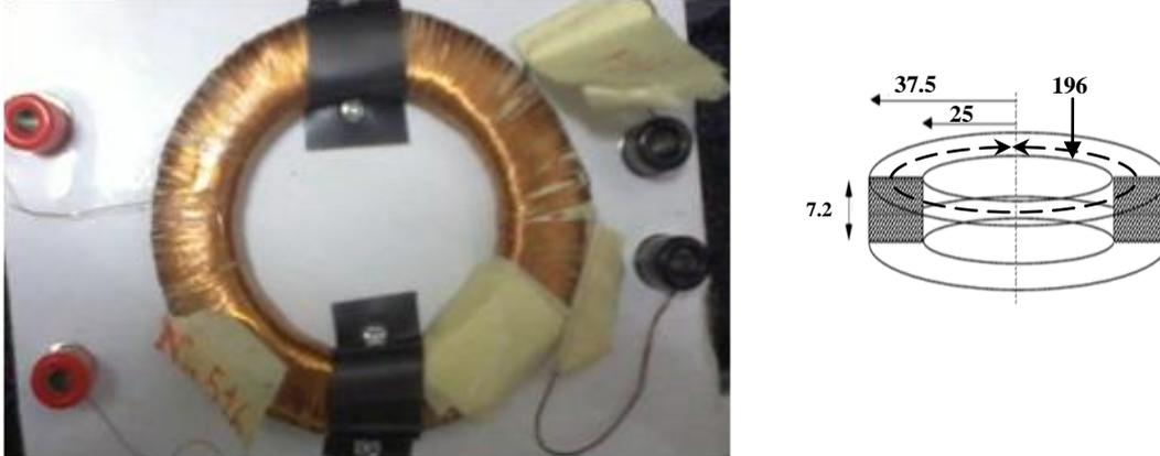
Fig. III.1. Tore en acier à caractériser, dimensions en mm
