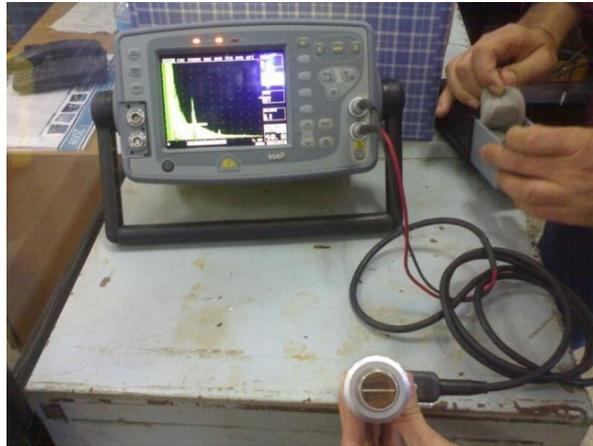
Fig. I. 3. Appareillage de contrôle par ultrason.
