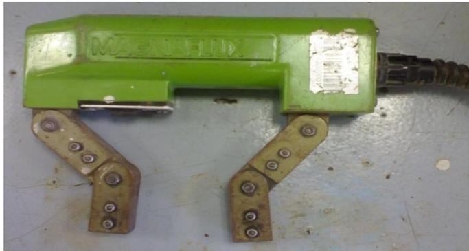
Fig. I. 6. Appareil de contrôle par magnétoscopie.
