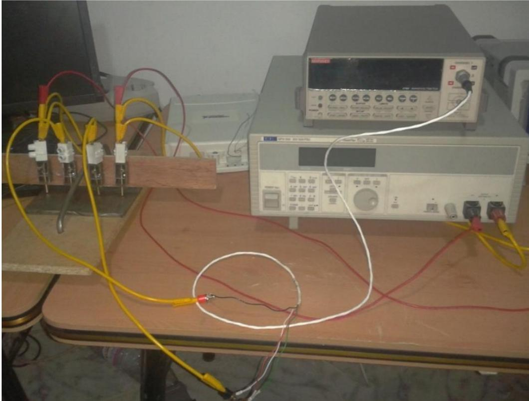
Fig. III. 7. Mesure expérimentale de la conductivité électrique par quatre pointes
