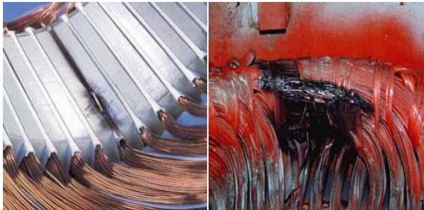
Figure I.6. Exemples de dégâts dus au défaut de court-circuit statorique d'un moteur asynchrone [Yah 12].
