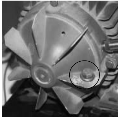
Figure IV.15. Boulon fixé sur une pale du ventilateur [Sal 14].
