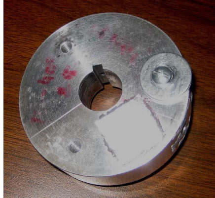
Figure IV.13. Moyeu avec un boulon, utilisé pour créer une variation de charge [Kor 10]
