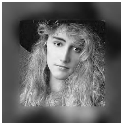
Figure 4.15: Image Hoed reconstruite 256x256 par SPECK modifié avec bandelettes (TC=91% , T_g=14 , rang=2 et PSNR=32.60 dB)
