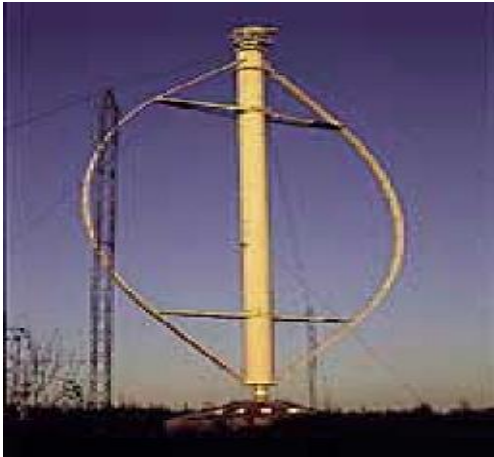
a :éoliennes à axe vertical.
