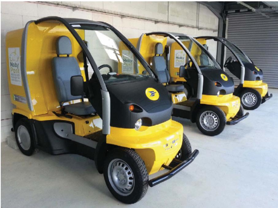
Figure 6.1: Véhicule hybride à pile combustible FCHEV «MobyPost»
