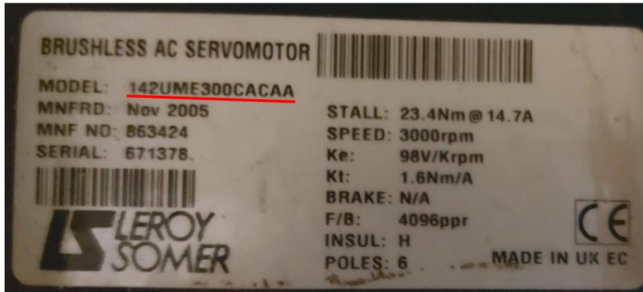
Figure C.3 : Plaque signalétique de la MSAP du laboratoire LSEE.
