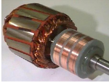
**Figure II.1 :** Rotor bobiné.
