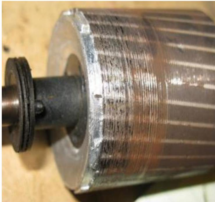
**Figure I.7 :** Effet du défaut d'excentricité sur le rotor d'une MAS [27].
