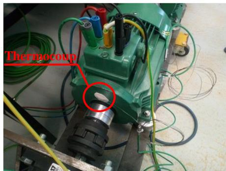
Figure IV.3 : Emplacement de la sonde de température sur la machine asynchrone.
