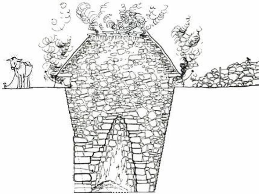
الشكل 19 : مخطط لفرن تقليدي خاص بصناعة التمشنت.
