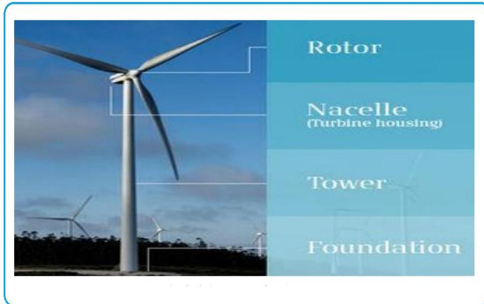
**Figure I.18:** Eléments constituant une éolienne à axe horizontal [34]
