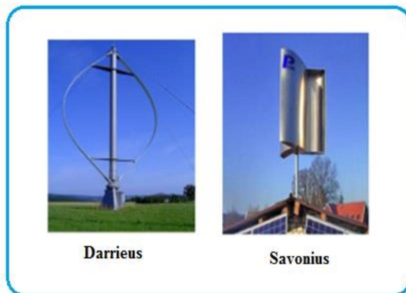
Figure I.13 : Technologie éolienne à axe vertical [22]
