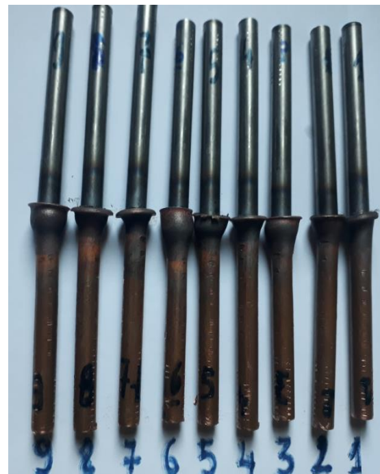
Figure III.13 : Pièces après soudage
