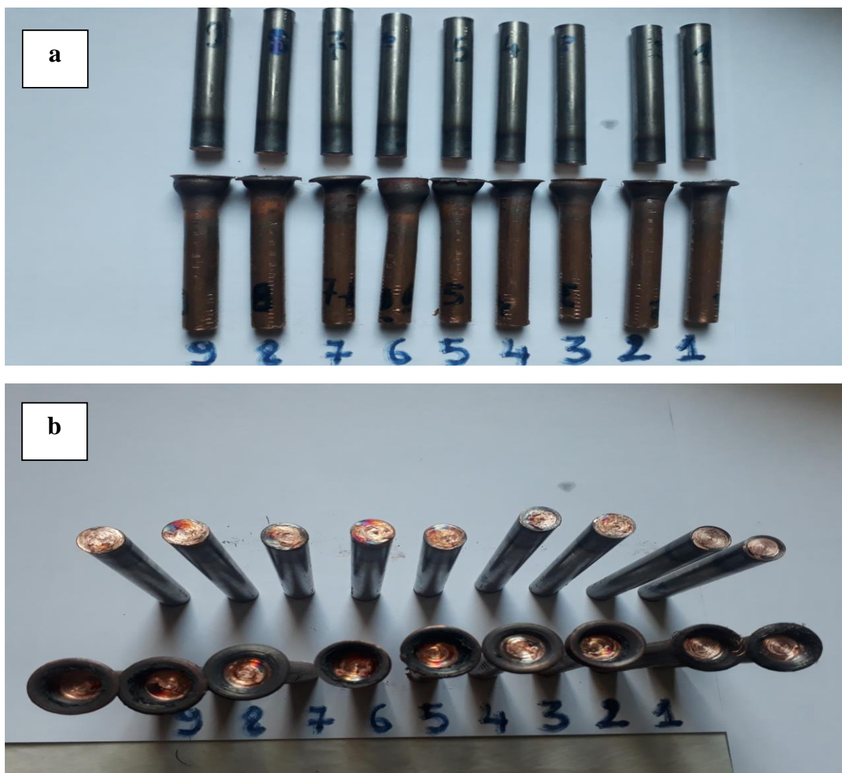
Figure III.16 : Observation macroscopiques après rupture des éprouvettes.
