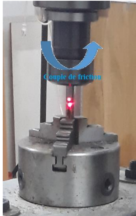
Figure III.9 : Phase d'accostage F1
