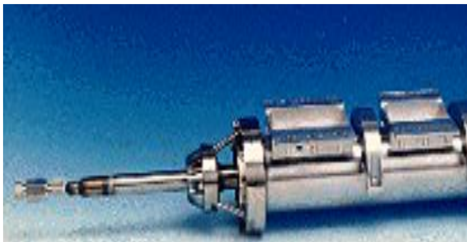
Figure I. 10 : Une pièce soudée par RFW utilisée dans les satellites. [8]
