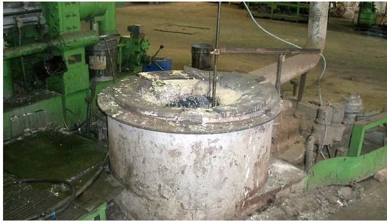
Figure III.2 : Four de maintien utilisé lors des coulées sous pression à ETRAG.
