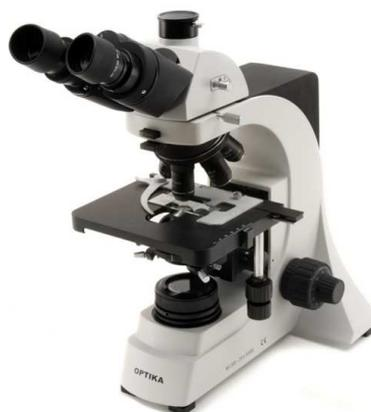
**Figure 57.** Microscope optique métallographique Optika B-500 MET (Laboratoire LGEM).
