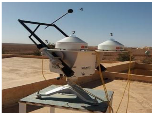
Figure 4.4. Instruments de mesure du rayonnement solaire global, direct et diffus : (1) pyranomètre pour l'irradiance diffuse. (2) pyranomètre pour l'irradiation solaire globale. (3) pyréliomètre pour la composante à éclairage direct. (4) Le ballon sert à cacher le pyranomètre de façon permanente.
