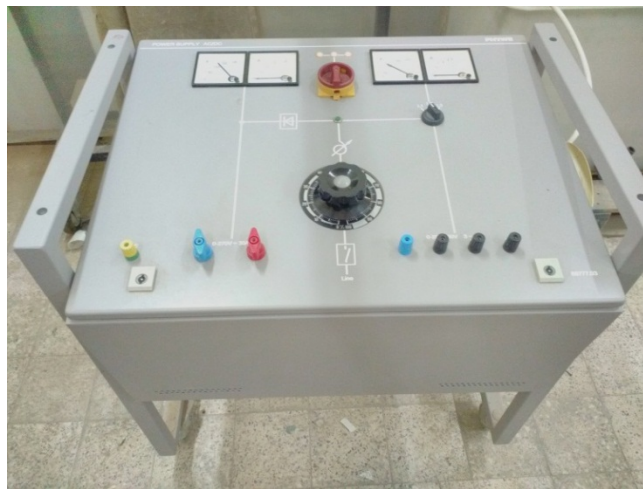
Figure 3.9 Alimentation électrique AC/DC
