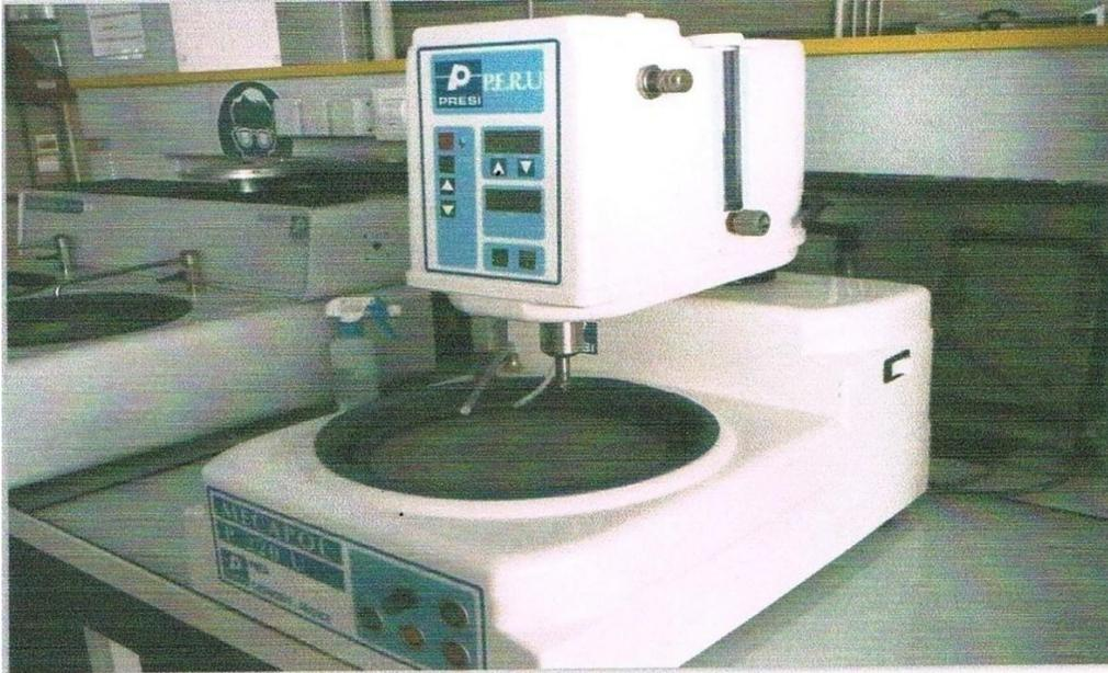
**Figure II.1** : Polisseuse de type Presi Mecapol P200
