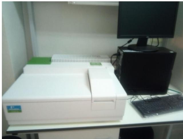
**Figure II-15** : Spectrophotomètre UV-Vis perkinelmer Lambda 35
