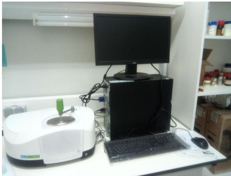
**Figure.17.** : Spectrophotomètre FTIR perkinelmer Spectrum Two.
