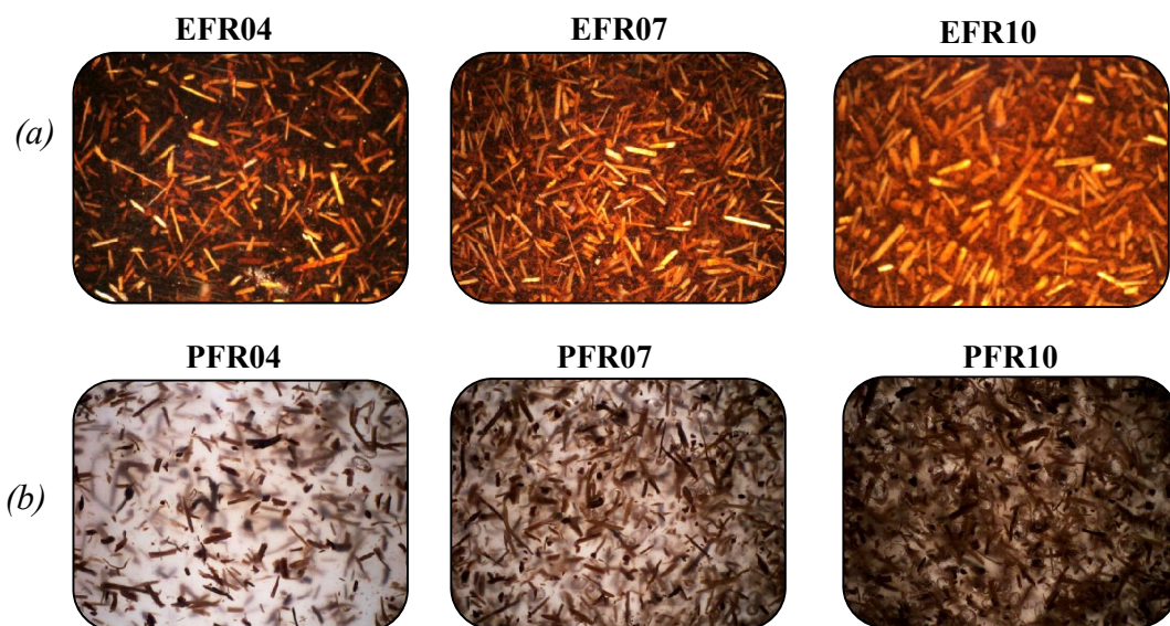
Figure III.22. Observations microscopiques des plaques en matériau composite pour différents taux de fibres: a) EFR (X 10), b) PFR (X 10).
