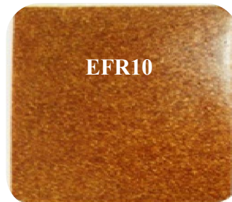
Figure IV.2. Composite EFR10 utilisé comme peau des structures sandwichs.
