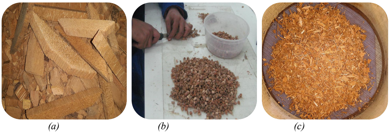
Figure III.2. Préparation des particules de bois de pétiole : a) déchets de bois, b) découpage, c) tamisage.
