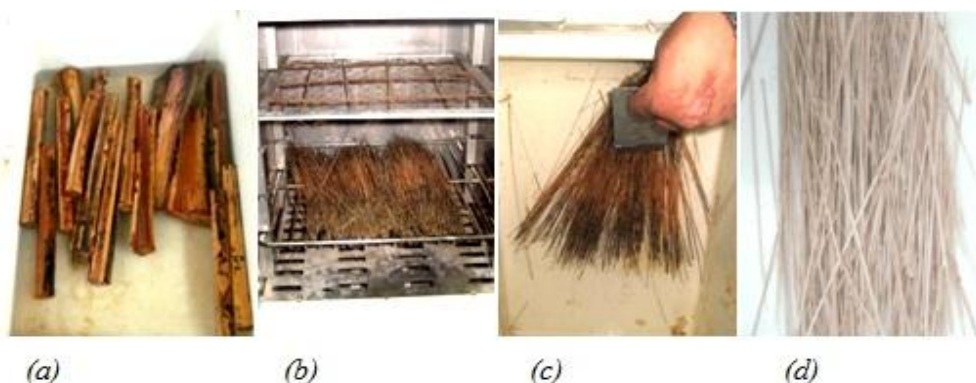
Figure II.6. Processus d'extraction des fibres des tests mécaniques : a)rouissage, b)séchage, c) lavage, d) fibres.
