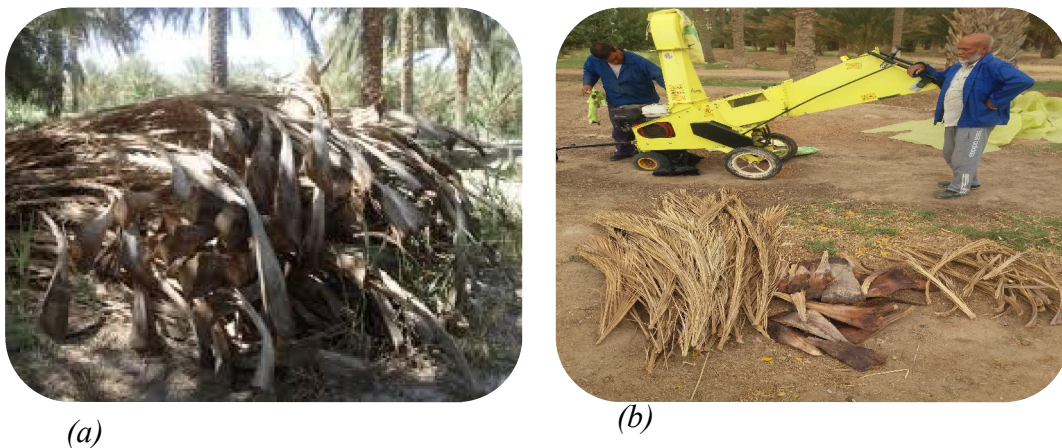
Figure.0.2. Déchets de palmier dattier: a) collecte des déchets, b) broyage de déchets.
