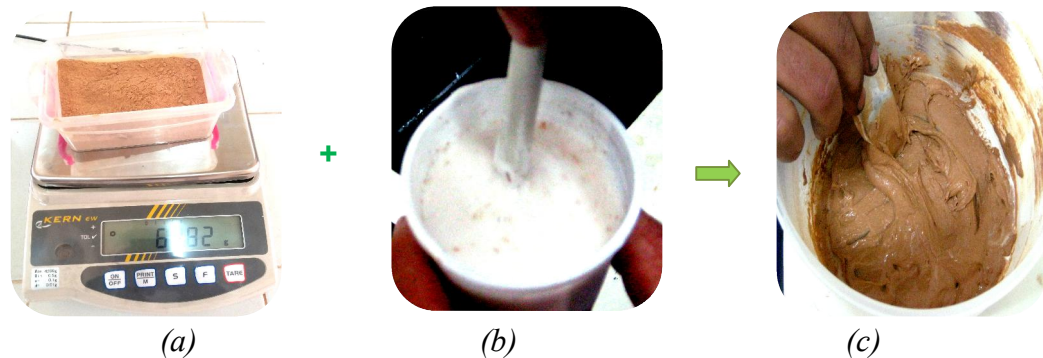
Figure III.6. Protocole de préparation de la colle naturelle : a) poudre de lignine, b) colle vinylique, c) pâte de colle naturelle.
