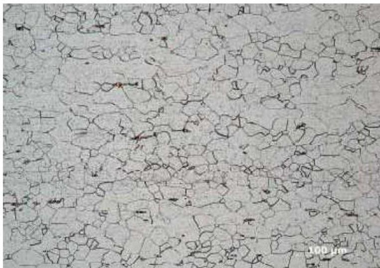
Figure II.9 : Structure d'un acier inoxydable ferritique [22].
