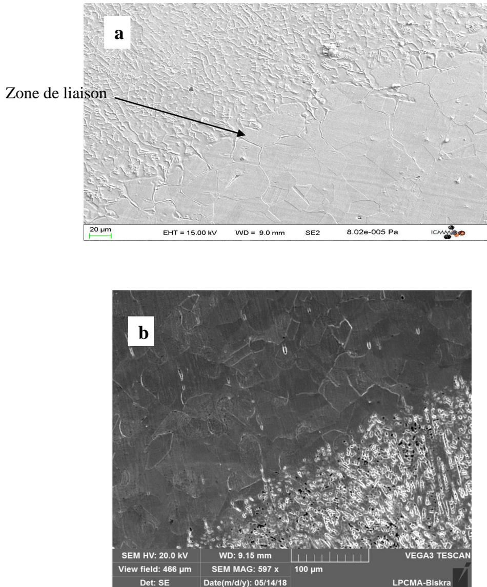
*Figure V.4: Microstructure obtenue par le MEB de la zone de liaison non traité.*
