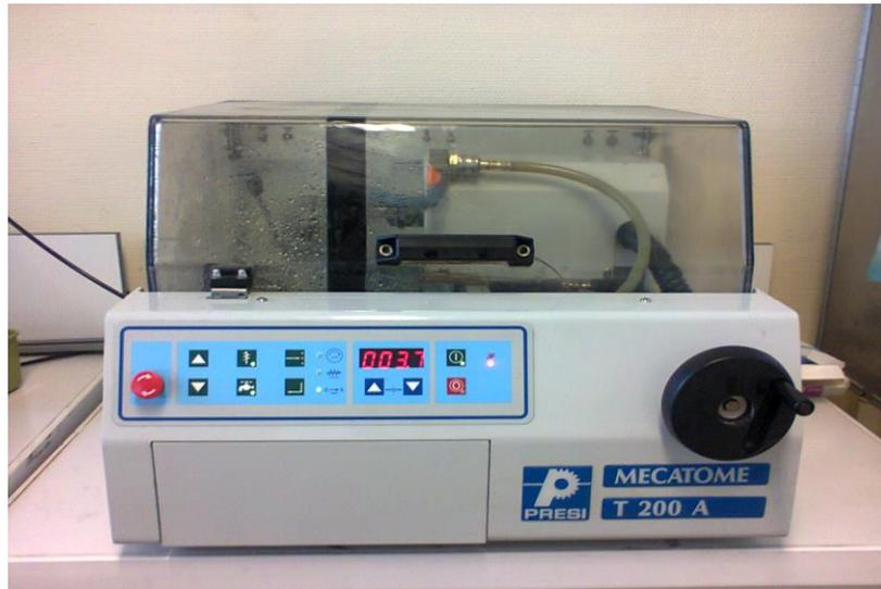
*Figure IV.2: Machine de découpe d'échantillons.*
