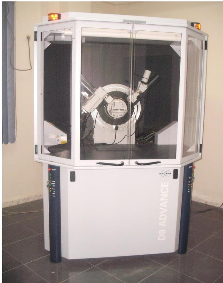
*Figure IV.4 : Diffractomètre de type Bruker D8 Advance.*
