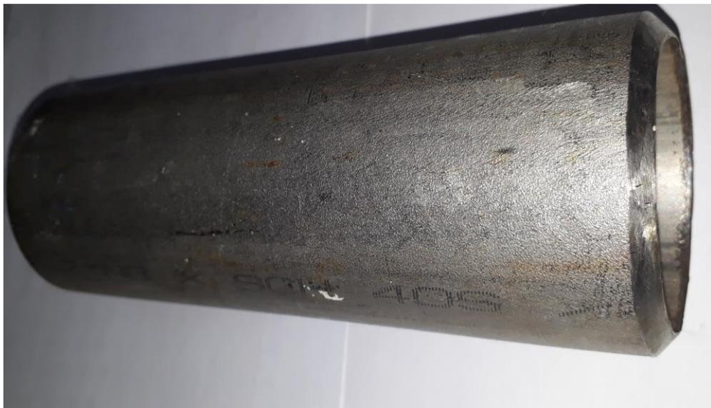
*Figure IV. 1: Tube d'acier inoxydable 304 L.*
