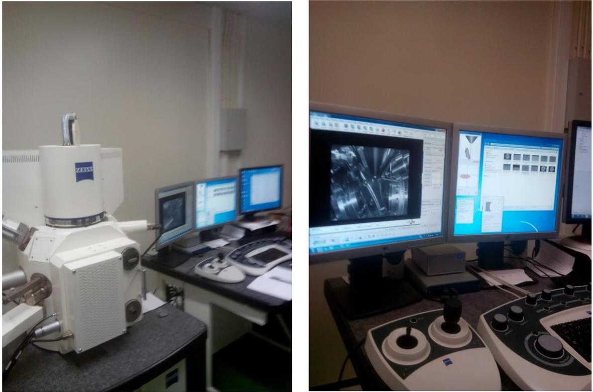
*Figure IV.7 : Appareillage EBSD utilisé.*
