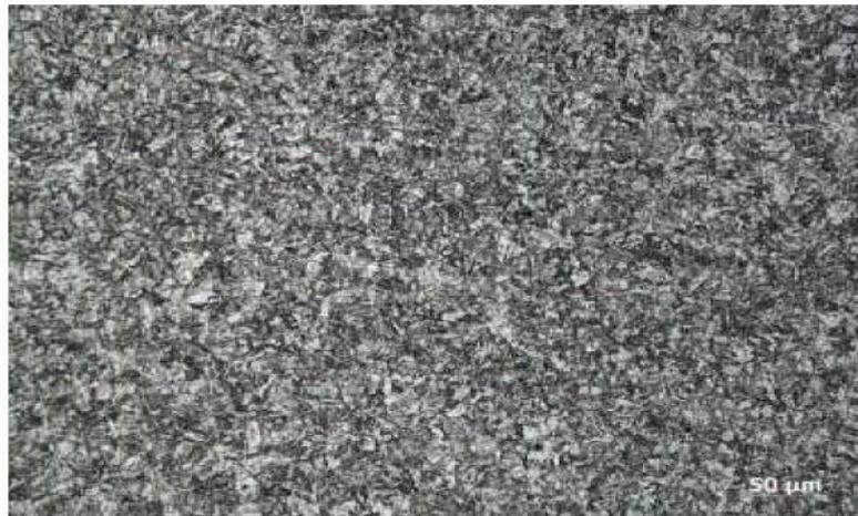
*Figure II.10: Structure d'un acier inoxydable martensitique [22].*
