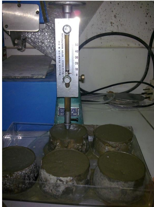
Figure.IV. 8. Test de prise Vicat des pâtes bois – ciment en fonction du dosage en bois.
