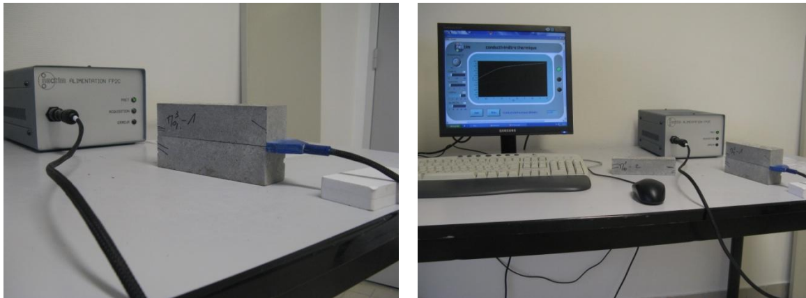
Figure.IV. 10. Mesure de la conductivité thermique par la méthode fil chaud.
