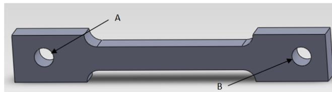
**Figure (III.8) :** Spécimen métallique démontable
