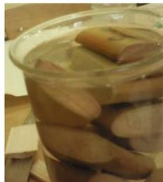
**Figure (IV.68):** Procédure d'absorption de l'eau.
