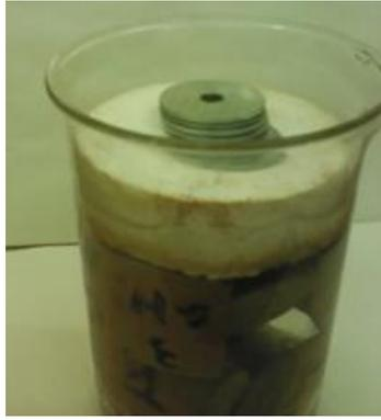
**Figure (III.19):** Masselotte sur pièce circulaire de polystyrène
