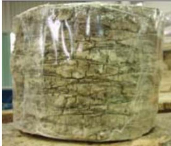
**Figure (II.15) :** Coupe longitudinale d'un morceau de tronc du palmier dattier. [80]
