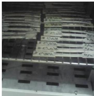
**Figure (III. 24) :** Description les spécimens dans l'étuve
