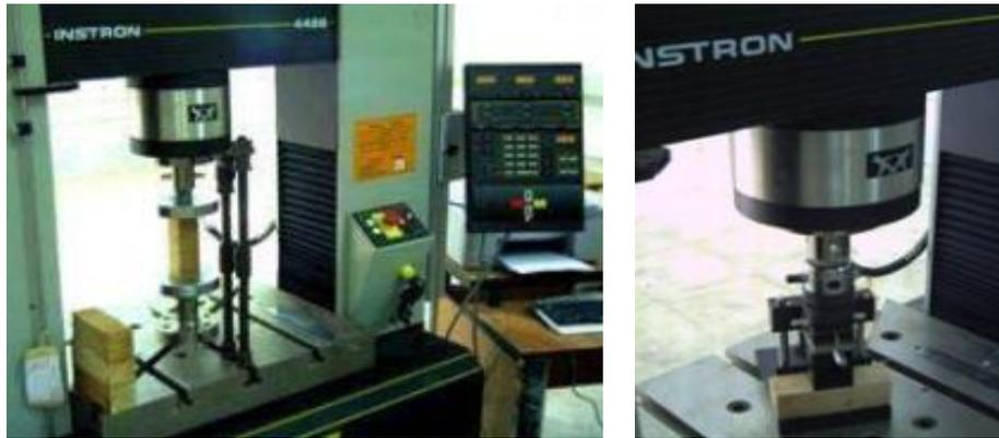
**Figure (II.17) :** Représente les essais mécaniques bois tronc de la compression parallèle et perpendiculaire aux fibres. [80]
