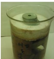
**Figure (IV.69):** Solution proposée pour l'immersion des éprouvettes de bois.
