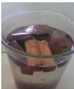
**Figure (IV.72):** Spécimens des différentes couches flottantes à la surface de l'eau.
