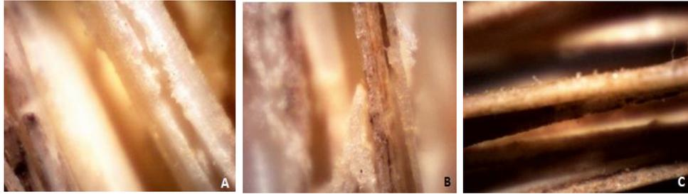
**Figure (IV.10):** Effet d'écrasement dans le sens longitudinal des fibres agrandissement 60 fois (A : Deglet Nour, B : El Ghers, C : Mech-Degla).
