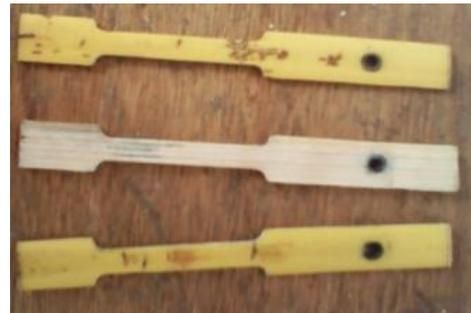
**Figure (III.23) :** Spécimens après l'usinage
