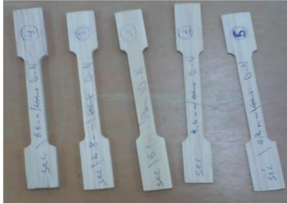
**Figure (III.25) :** Spécimens préparés avant essais de traction
