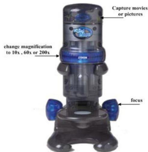
**Figure (III.1):** Le microscope optique digital (DigiBlue QX5 QSG).
