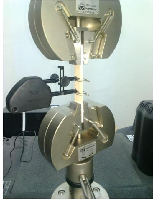
**Figure (III.5) :** Extensomètre placé sur
