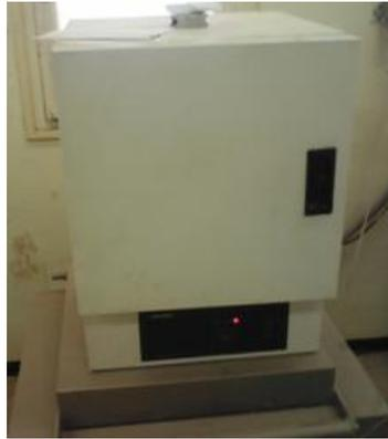
**Figure (III.3) :** Etuve d'humidité
