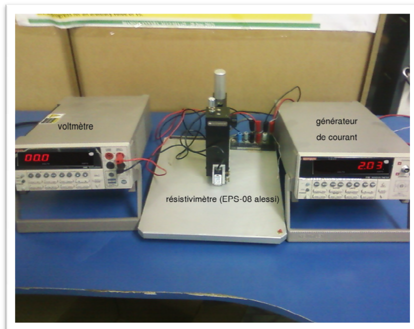
Figure III.11.a: Montage expérimental de la technique des quatre pointes [38].
