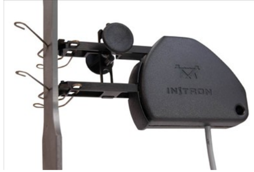
Figure IV.9 : Extensomètre placé sur l'échantillon à tester.
