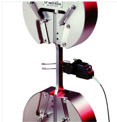
Figure IV.10 : dispositif de positionnement de l'extensomètre.
