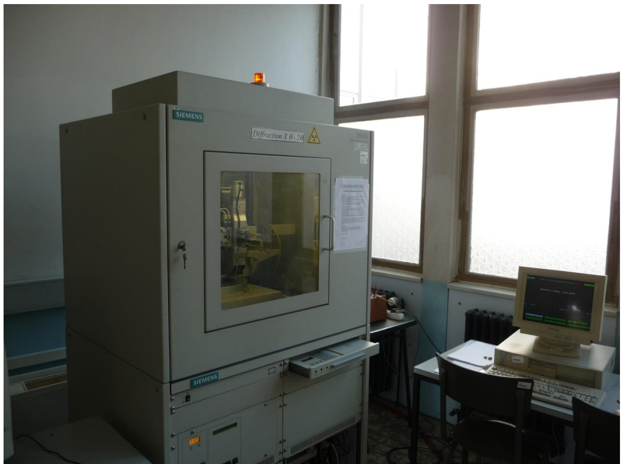
Figure III.12 : Diffractomètre de rayons X / SIEMENS D-5000 0-20.
