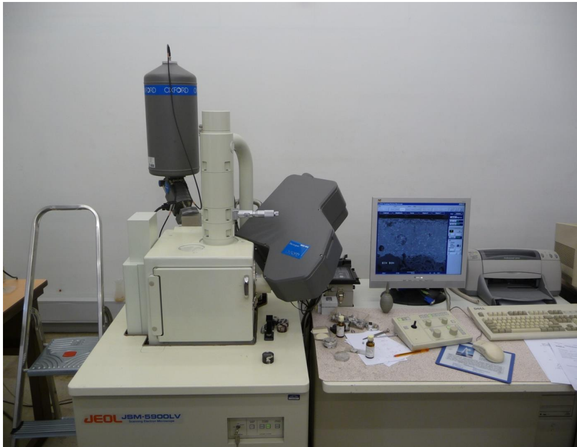
Figure III.7 : MEB: JEOL 5900 avec EDX et WDX OXFORD instruments.
