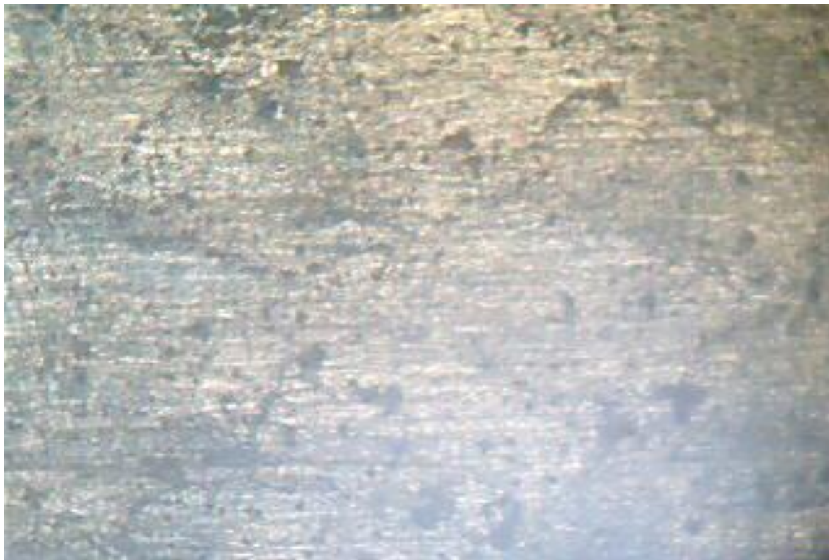
Figure IV. 17 : Microstructure de la surface usinée après le test de corrosion agressive de l'acier XC18 usiné avec une vitesse V4 ( 60 m/min) puis immergé dans l'eau de mer pendant 48 heures.
