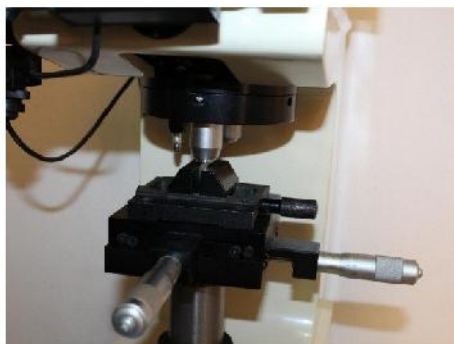
Figure III.6-a : Vue agrandie du porte échantillon et pénétrateur.
