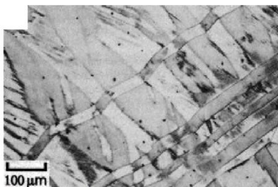
Figure I.15. Laiton 70:30, comprimé à 12%, présentant des bandes de déformations [51].
