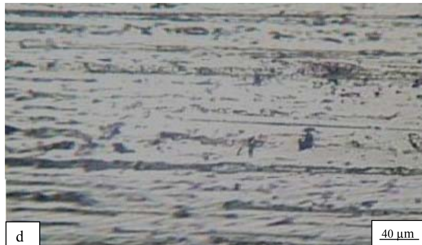
Figure V.2: Evolution de la microstructure en coupe longitudinale du fil d'aluminium tréfilé à taux de réduction de 96.41 % et recuit à 400 °C pendant 1h, (a) : avant fluage, (b) : 1 er stade, (c) : 2eme stade et (d) : 3 eme stade de fluage et sous 91 MPa et 160 °C.
