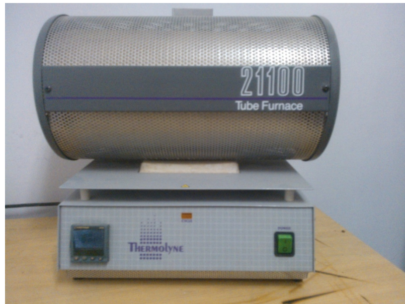
Figure III.2 : Four de traitement thermique.
