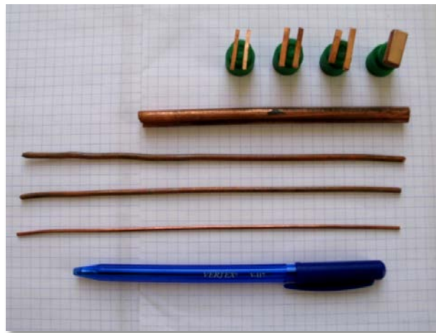
Figure 3.18 : Echantillon de fils de cuivre tréfilés puis découpés.
