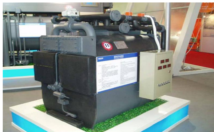
Figure 4.3 : Photo du refroidisseur à adsorption (Zhai et al. 2008).
