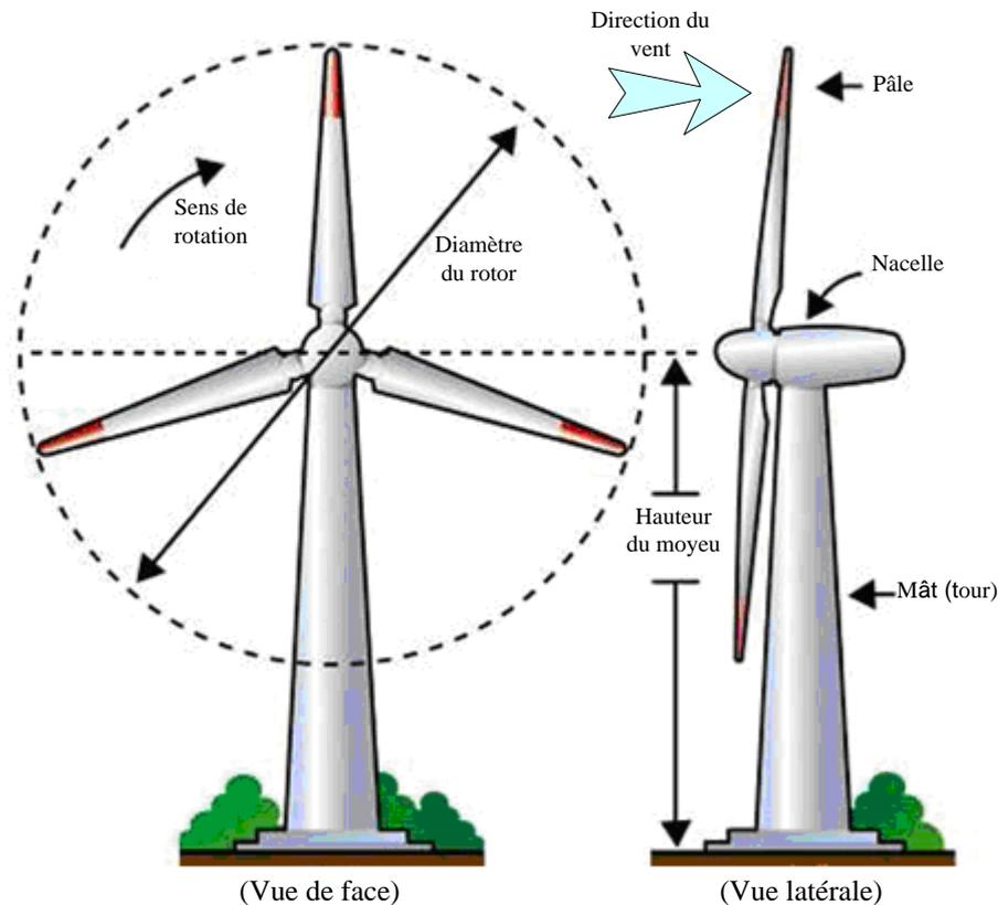
Figure 1.2 : Schéma d'ensemble d'une éolienne [1]
