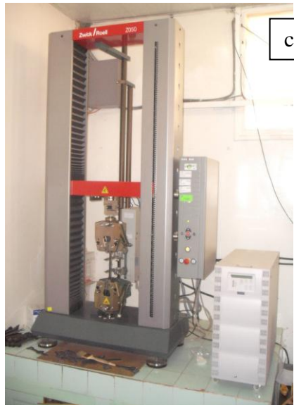
Figure 52 : Contrôle et test du métal de la bouteille à gaz.
