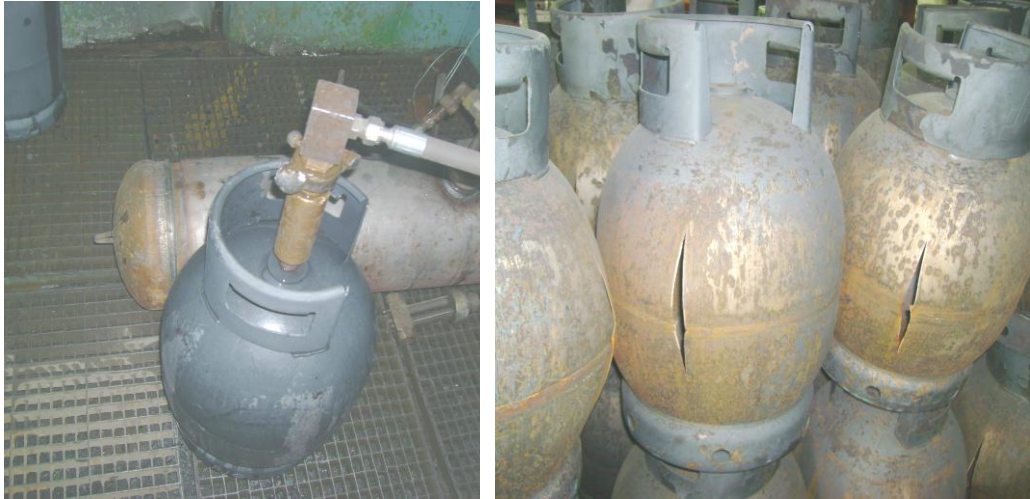
Figure 53: Echantillons de bouteilles éclatés après test d'éclatement.
