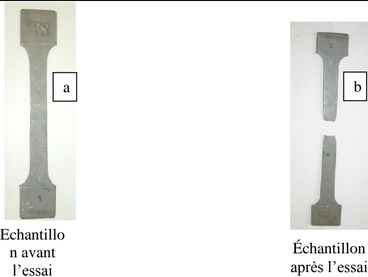
Figure 97 : Epreuve de traction avant (a) et après (b) essai de traction de la tôle d'acier à 0,19 % C.
