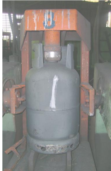
Figure 51 : Contrôle à la pression hydraulique de 30 bars
