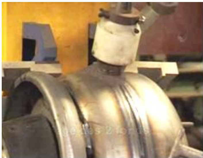
Figure 8 : Procédé de soudage automatique électrique à l'arc d'une bouteille à gaz.
