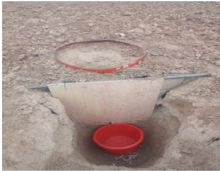
Figure N° 27 : un lysimetre cylindrique mis en place au niveau du site expérimental de l'Outaya
