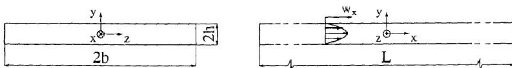
Figure.(I-1) : Schéma d'un capteur avec un conduit de section étroite [1].
