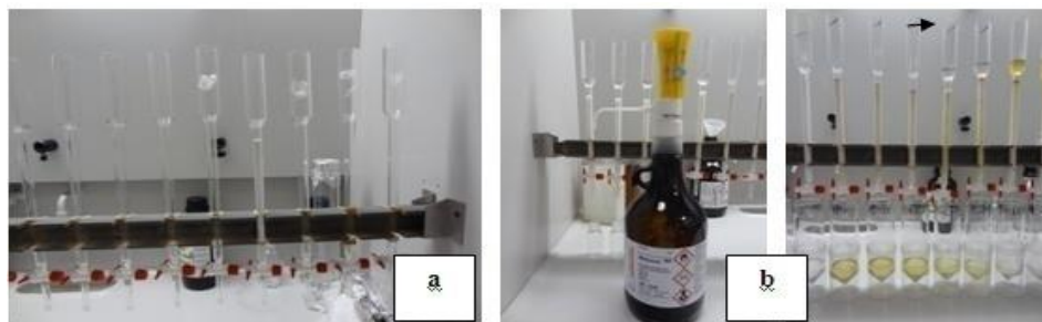
Figure 28 : Les étapes de la purification des extraits à partir d'échantillons sol.
