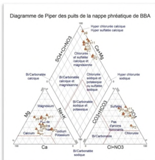
Fig. 46 : Diagramme de Piper des eaux des puits de la nappe phréatique de BBA utilisées en irrigation des palmeraies. (Simler, 2013).
