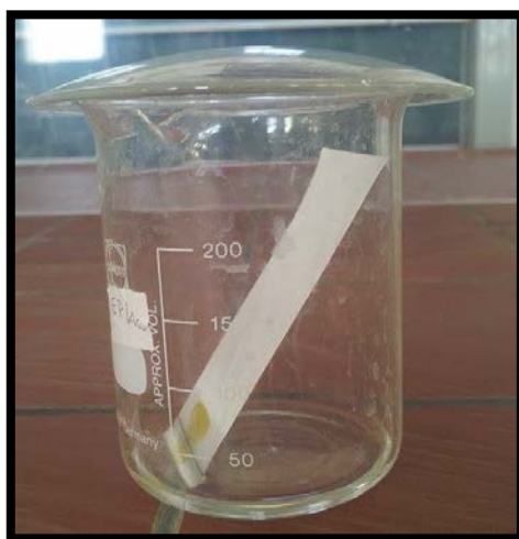
Fig.23 : Cuve de CCM
