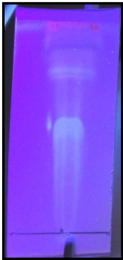
Fig.228 : Révélation aux UV des flavonoides de Rosmarinus officinalis sur plaque de CCM dans le système (toluène/ethanol/méthyléthylcétone)(4/3/3)
