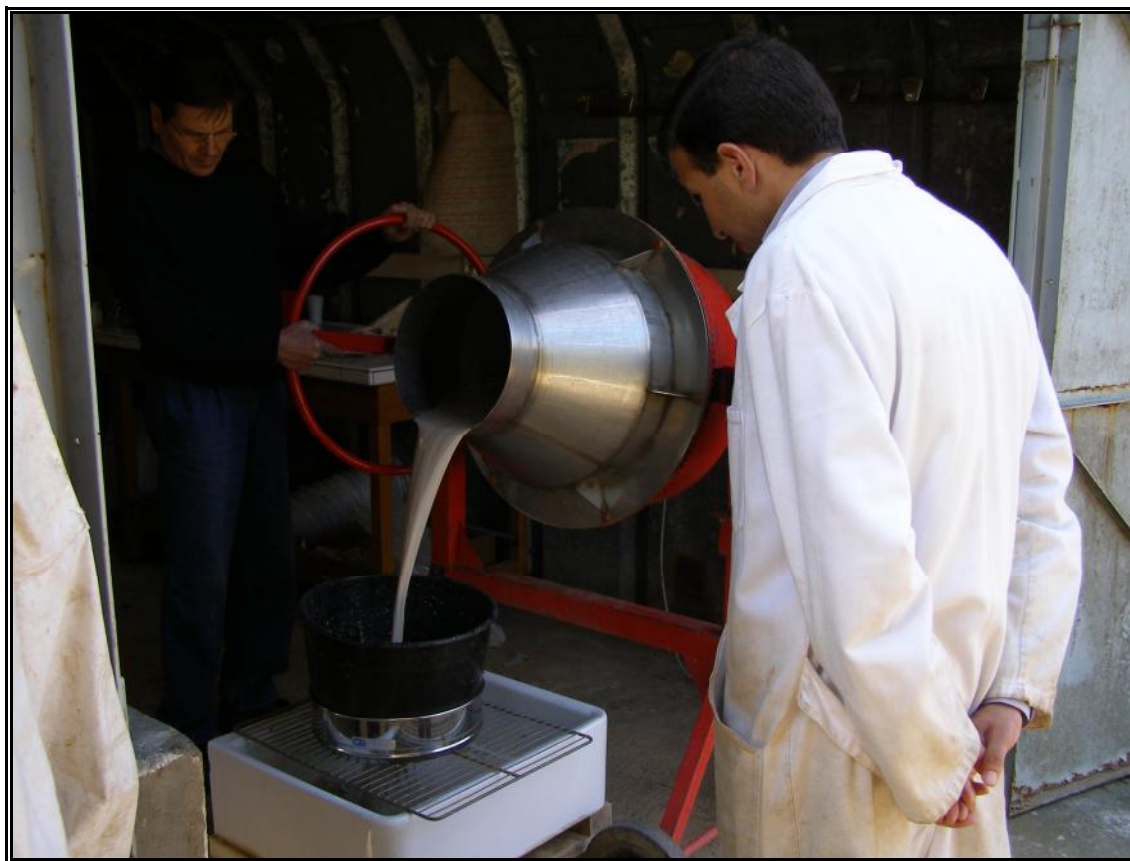
Figure III. 21. L'extraction des charbons à partir du sédiment par un malaxeur
